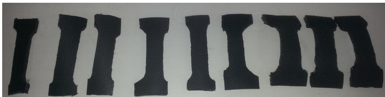
Figura 3.1 – Corpos de prova feitos e ensaiados no GMAP. Da esquerda pra direita se encontram os 3 corpos de prova da categoria 0°, os 3 do meio são os da categoria -33° e os 3 últimos os da categoria 57°.
