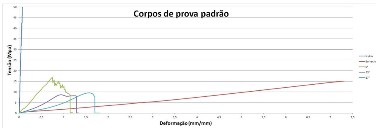
Figura 3.4 – Curvas de tensão x deformação dos corpos de prova escolhidos como padrão.
