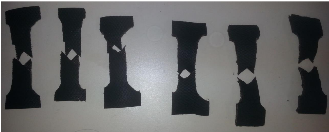
Figura 4.3 – Foto da forma da falha dos corpos de prova das categorias -33^\circ e 57^\circ após o ensaio de tração.
