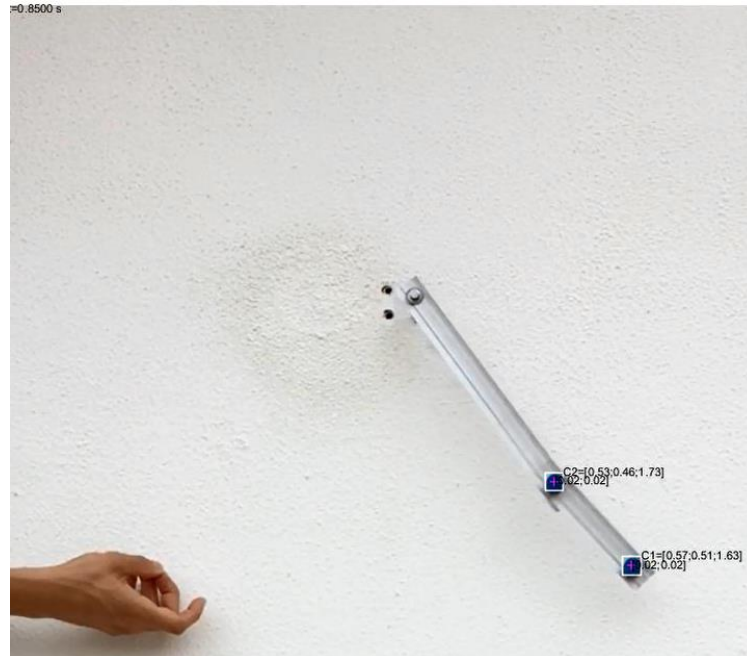
Figura A.2 - Quadro (Frame) para t=0,85 s do sistema óptico mostrando o posicionamento e reconhecimento dos marcadores ( \theta_1 = -31^\circ e \theta_2 = -38,6^\circ , velocidades iniciais nulas).
