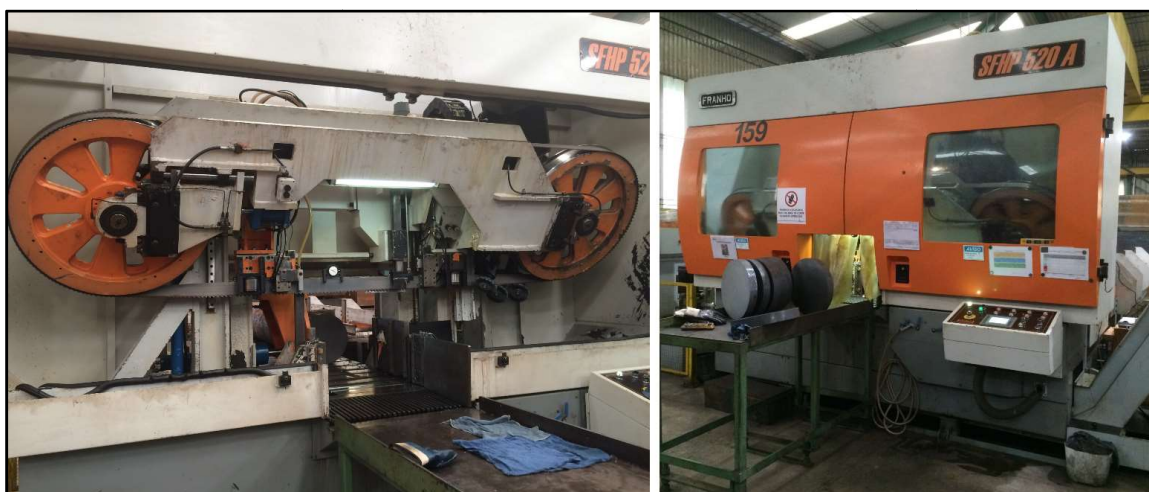
Figura 3.1 – Instalação da lâmina nova na máquina e corte do primeiro conjunto de amostras.
