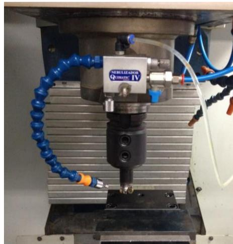
Figura 4.3 – Sistema experimental destacando o Nebulizador IV Tapmatic.
