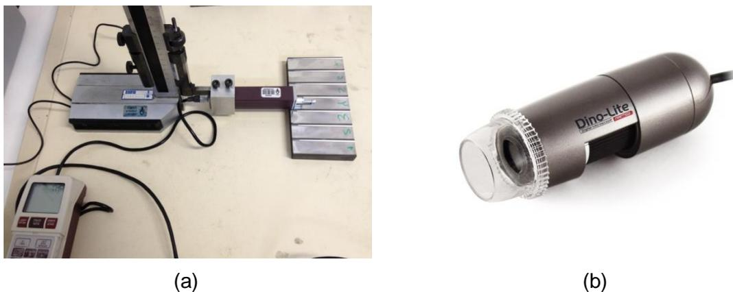
Figura 4.6 – Equipamentos para avaliação do acabamento da superfície usinada: (a) Rugosímetro SJ-201; (b) Microscópio digital Dino-Lite AM-413 ZT.
