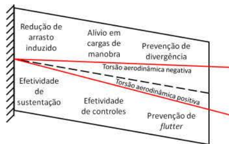
Figura 3.1 – Influência da rigidez direcional nas características de uma asa com enflechamento positivo [Shirk et al. , 1985].
