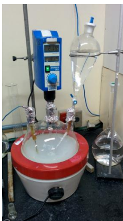
Fig. 4.2. Sistema de mistura utilizado na precipitação do pó de CaP. Composto por manta elétrica, balão de fundo redondo de 3 bocas, termopar, agitador elétrico e funil de decantação.
