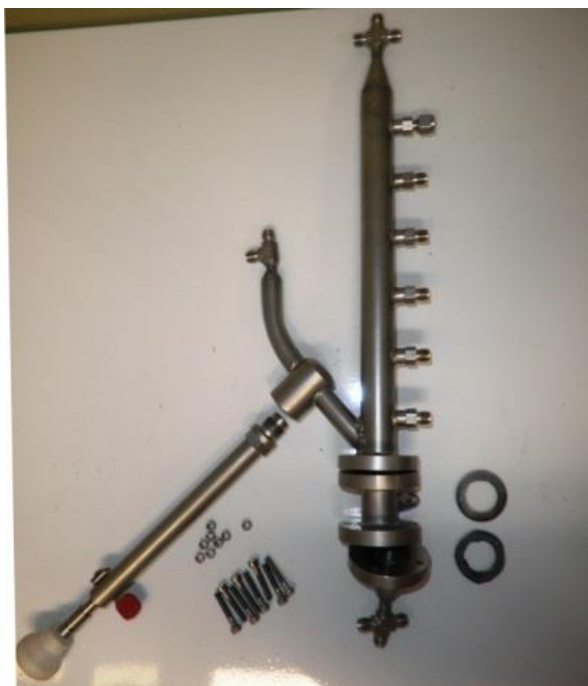
Figura 21: Reator de pirólise com sistema de alimentação por pistão.
