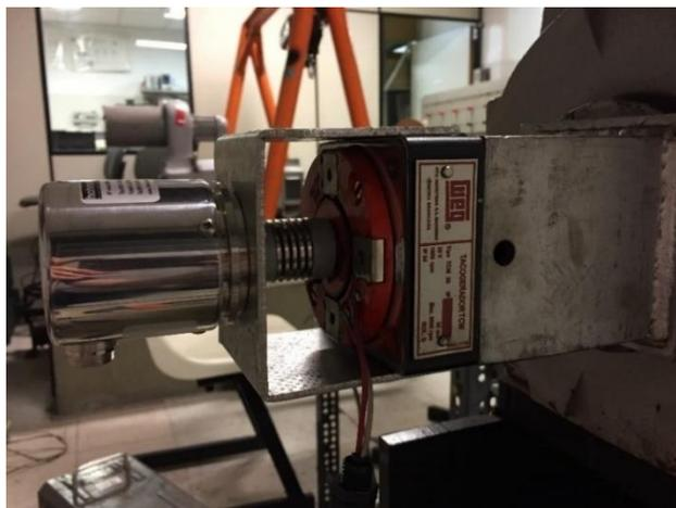
**Figura 11** Acoplamento mecânico do *encoder* incremental.
