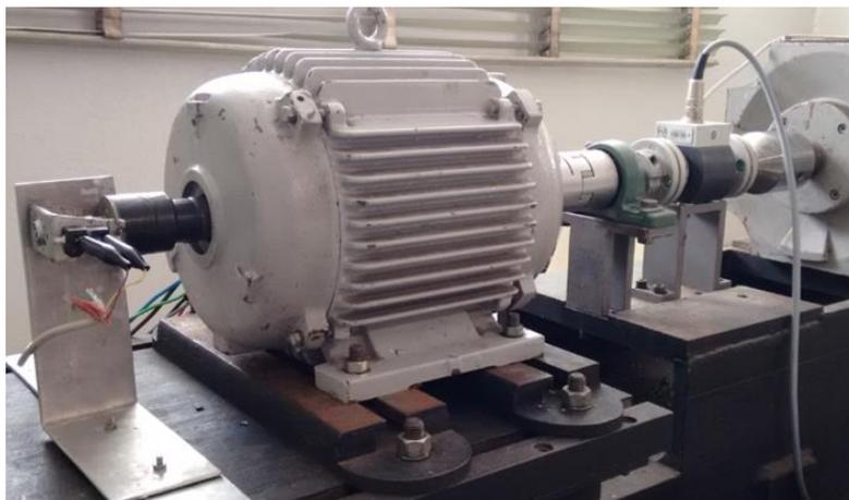
**Figura 65** Arranjo montado para medição de temperatura do rotor.
