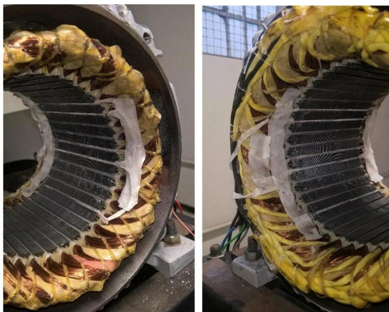
**Figura 16** Construção de bobina exploratória
