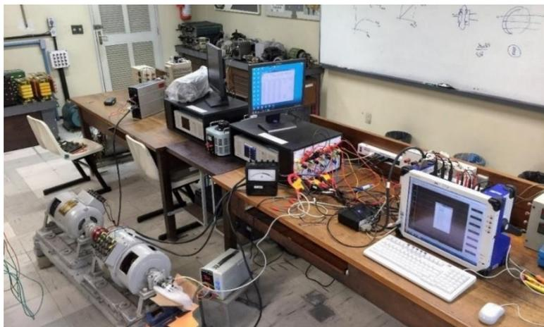
**Figura 44 Bancada de testes do gerador síncrono.**
