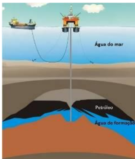
Figura 4 – Representação esquemática da localização da água de formação em um reservatório de petróleo (LEONARDO MITIDIERO, 2009).
