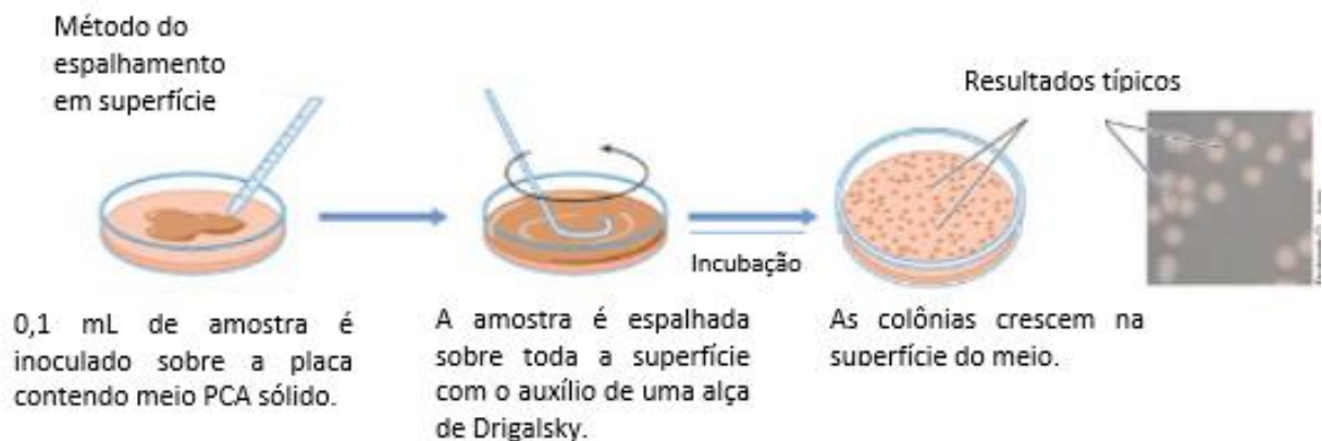
Figura 3.8: Método de espalhamento em superfície para contagem de heterotróficos.
