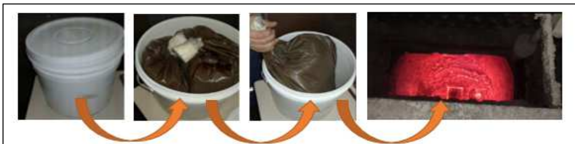
Figura 20: Massa de fluência livre com composição previamente acertada pelo fornecedor sendo aplicada. Fonte: (cortesia GERDAU S.A).
