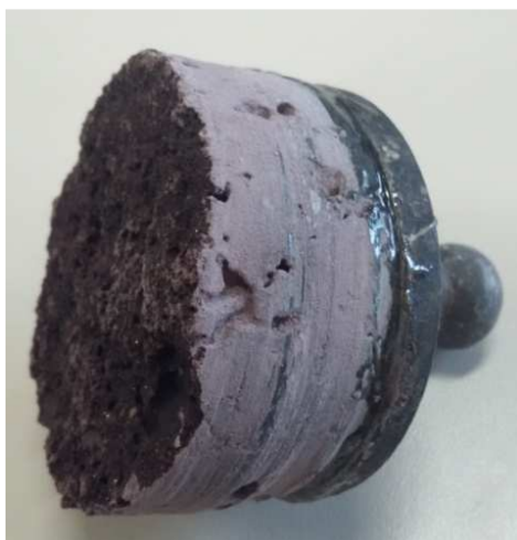
Figura 35: Massa Mag-2 fraturada após ensaio de adesividade.
