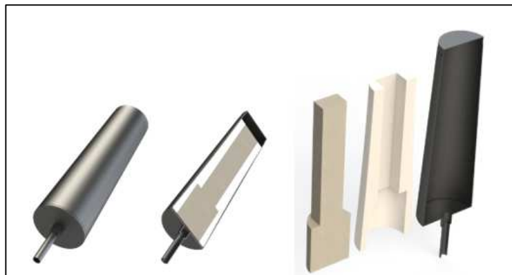
Figura 13: Esquema simplificado de um plugue poroso.
