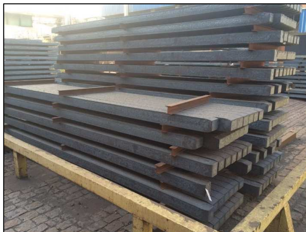
Figura 7: Tarugos produzidos no final do lingotamento contínuo. Fonte: (cortesia GERDAU S.A).
