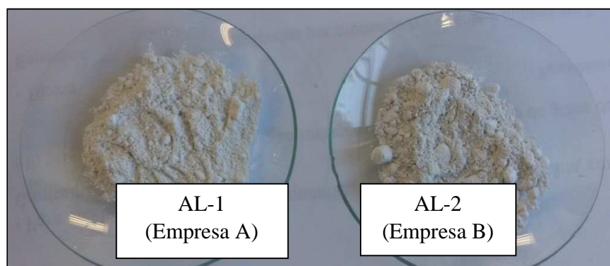
Figura 22: Análise visual das massas refratárias de reparo de sede: AL-1 (Empresa A), AL-2 (EMPRESA B).
