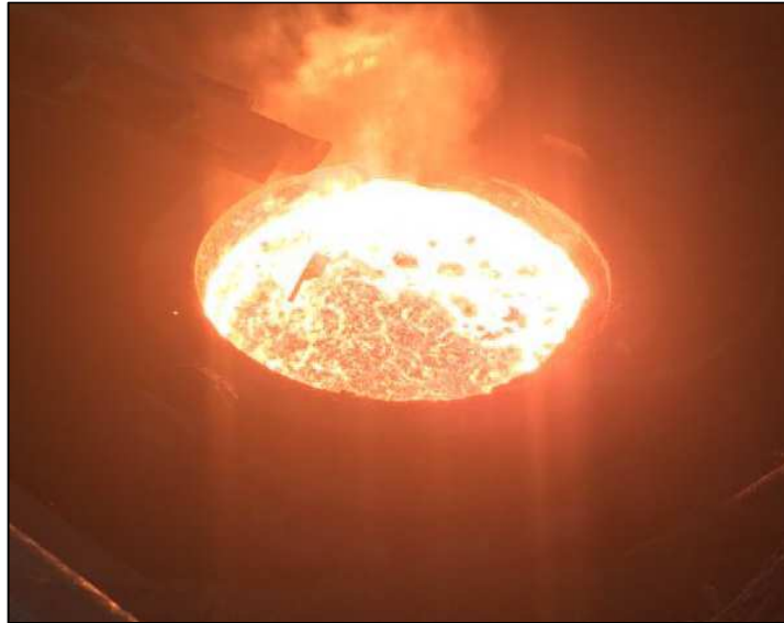
Figura 8: Painha com aço em estado líquido, logo após o vazamento do FEA. Fonte: (cortesia GERDAU S.A).
