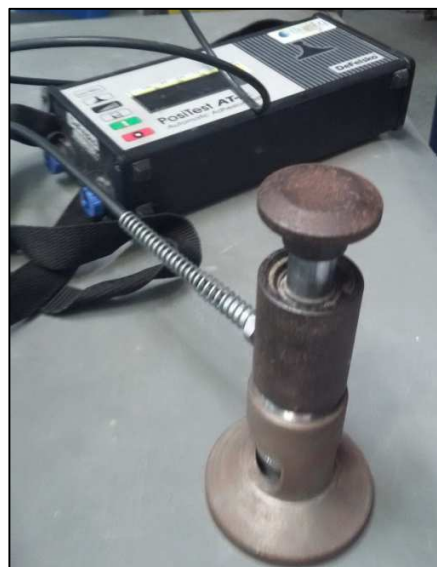
Figura 21: Equipamento utilizado no teste de determinação de aderência à tração.
