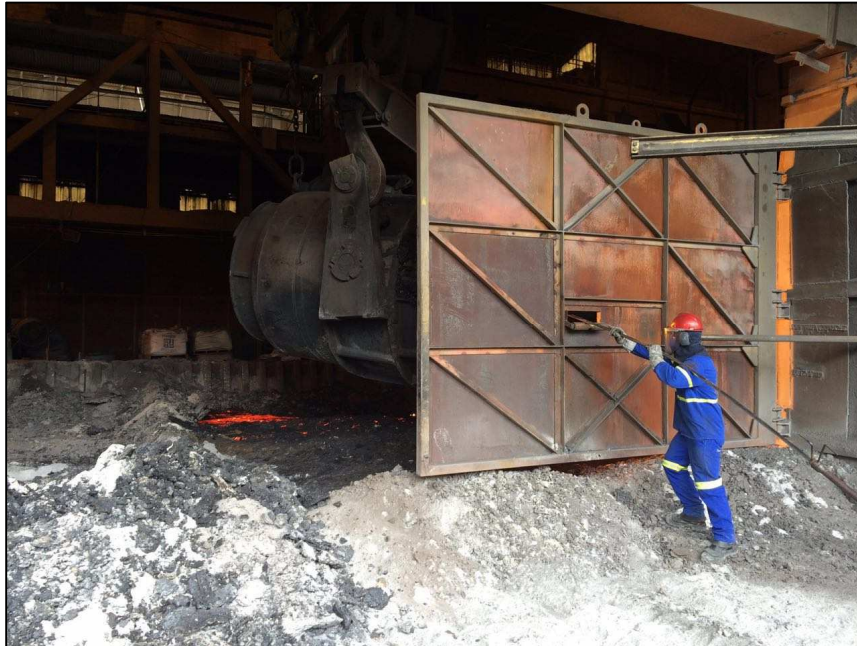
Figura 11: Momento em que ocorre a limpeza do sistema de rinsagem da panela após a mesma ter realizado uma corrida. Fonte: (cortesia GERDAU S.A).
