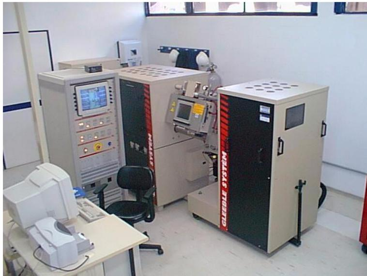
**Figura 19.** Simulador Termomecânico Gleeble 3500®.
