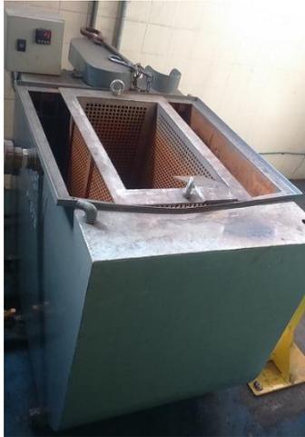
**Figura 23.** Tanque Fleron com agitação.
