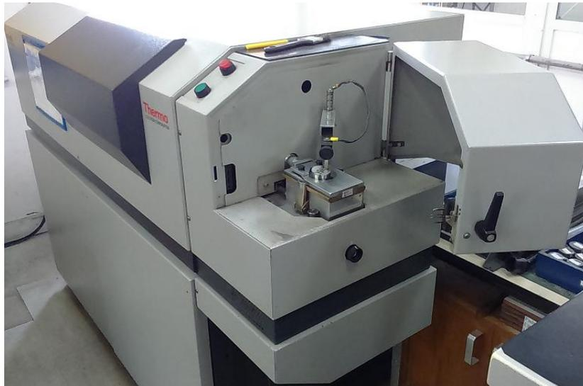
**Figura 17.** Espectrômetro de Emissão Ótica Modelo ARL- 4460.
