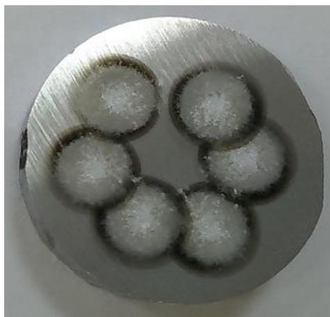
**Figura 18.** Amostra após análise em Espectrômetro de Emissão Ótica ARL- 4460.
