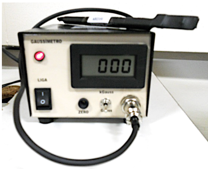
Figura 41- Gaussímetro utilizado neste projeto, construído no setor de Eletrônica do IF-UFRGS.
