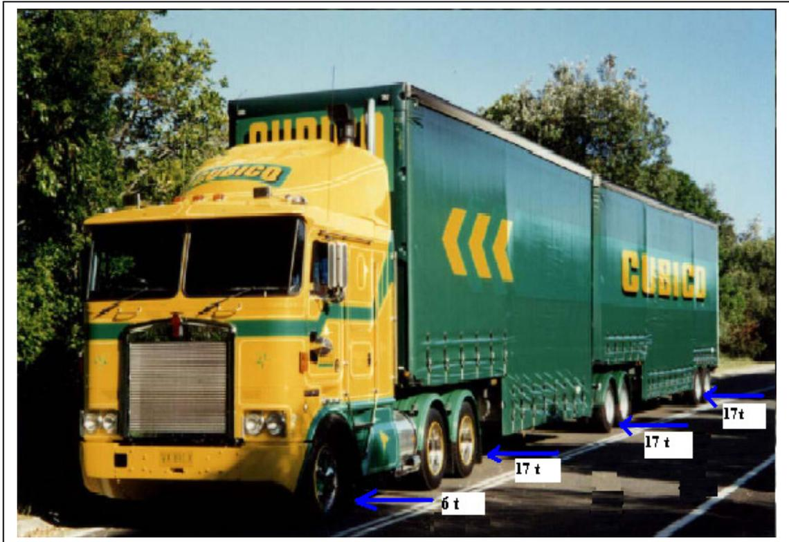
Figura 3.5 - Veículo tipo CVC – transporte de até 57 t
