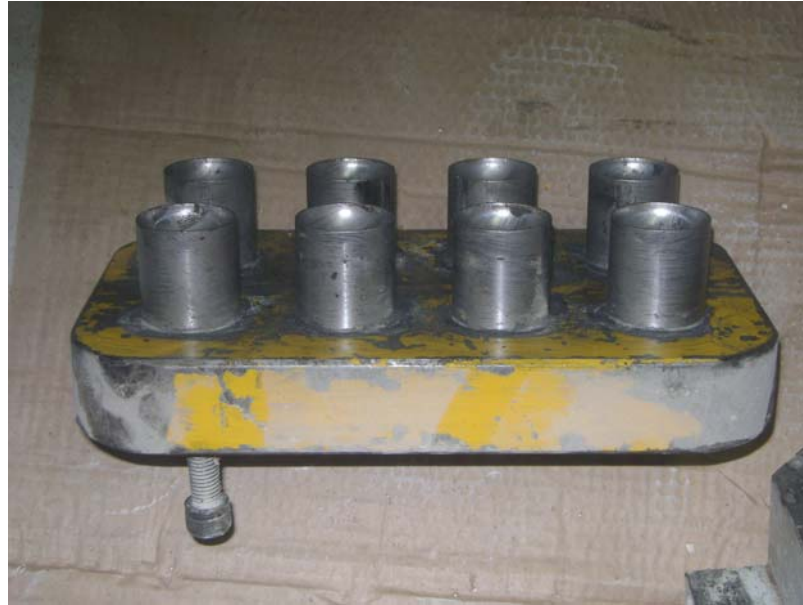
Figura 3.21 – Fixação dos punções superiores nas placas.
