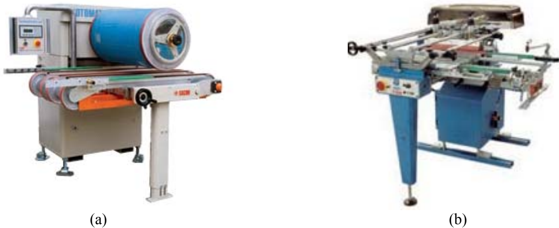
Figura 2.8 – Serigráficas: (a) Rotativa; (b) Plana (KINGERY, 1998).
