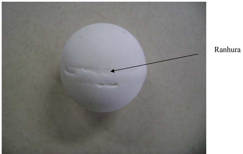
Figura 3.12 – Ranhura no esferóide após 24 horas do teste de desgaste.
