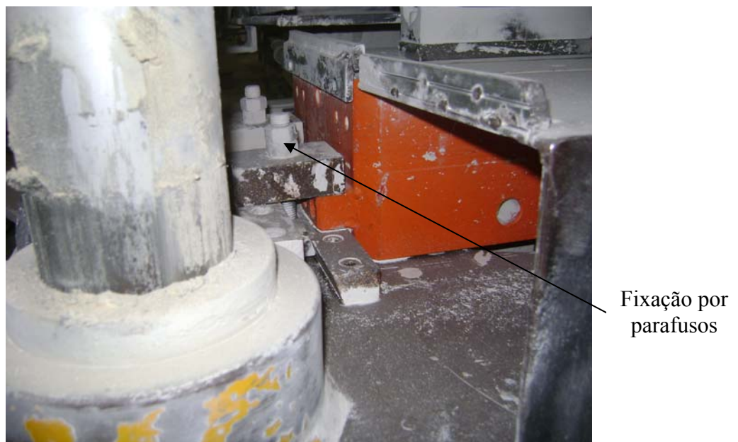
Figura 3.19 – Fixação da caixa matriz na travessa central da prensa hidráulica.
