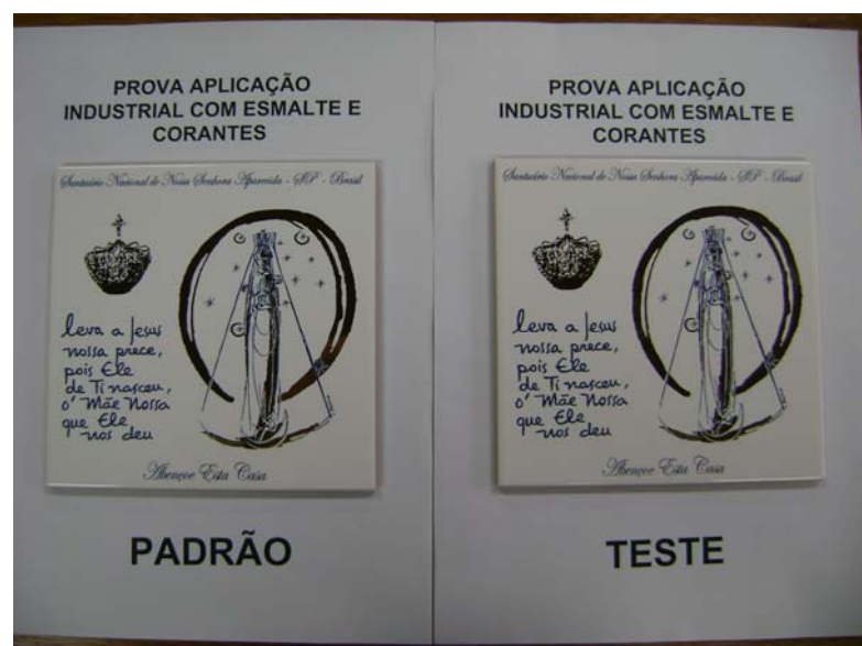
Figura 3.28 - Aplicação de esmalte e corantes em placas cerâmicas (esmalte teste produzido com esferóides compactados em prensa hidráulica).
