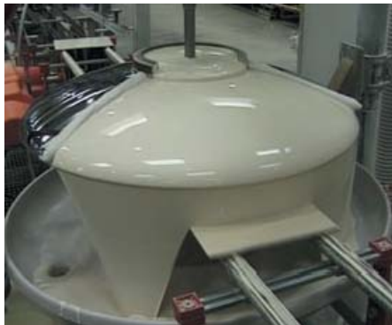
Figura 2.7 – Aplicação de esmalte (véu campana) (KINGERY, 1998).
