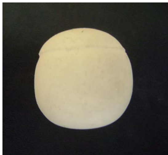
Figura 3.9 – Esfera produzida com prensagem isostática.
