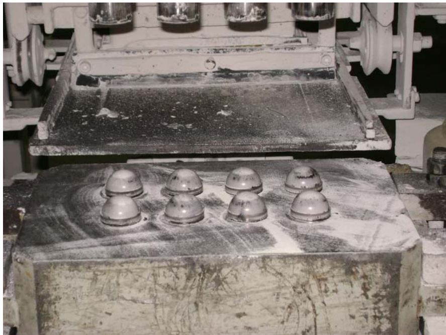
Figura 3.22 – Esferóide compactado no protótipo.
