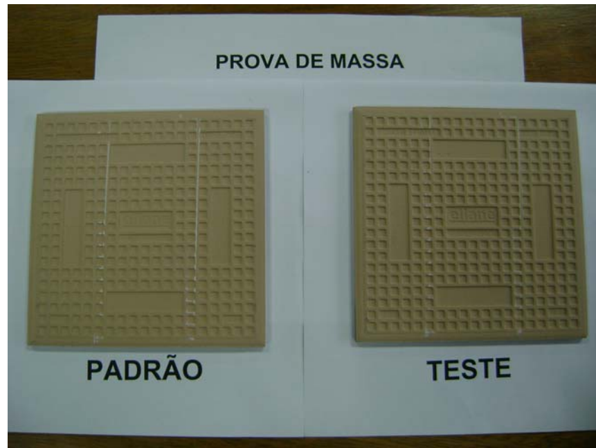
Figura 3.29 - Prova de compactação com massa cerâmica produzida através dos corpos moedores compactados através da prensagem hidráulica do protótipo.
