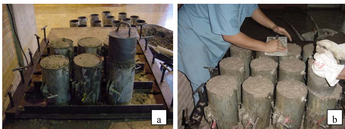
Figura 4.15 : Moldagem de corpo-de-prova. (a) vibração com contrapeso (b) Acabamento com contrapeso e desempenadeira.
