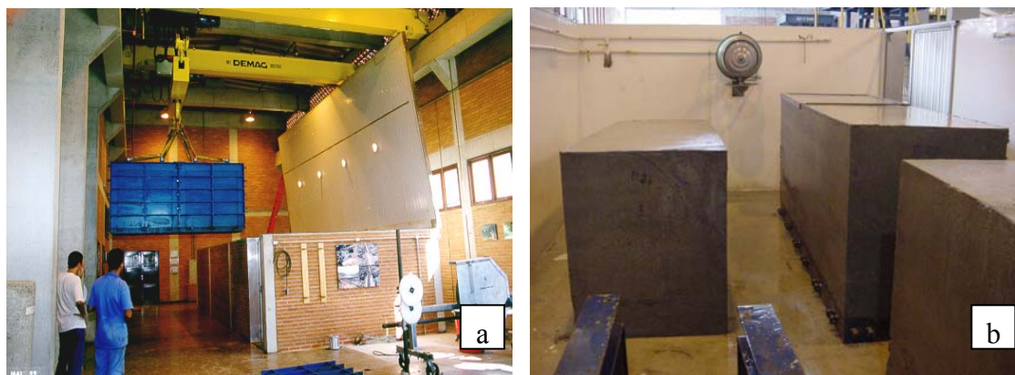
Figura 4.44 : Armazenamento do maciço. (a) transporte do maciço de CCR; (b) maciço de CCR na Câmara úmida.
