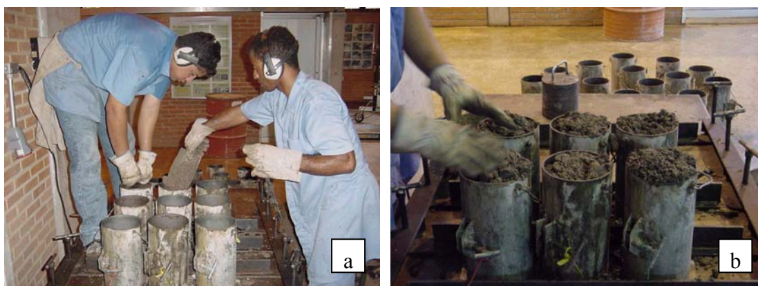
Figura 4.14 : Moldagem de corpo-de-prova. (a) preenchimento dos moldes - 1a camada; (b) preenchimento da 2a camada.
