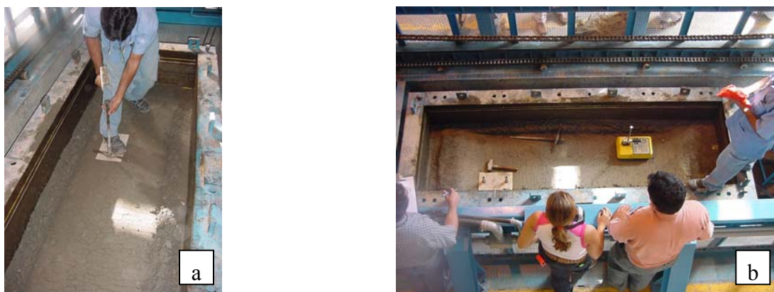
Figura 4.19 : Ensaio com densímetro nuclear. (a) execução de furo no maciço; (b) medição da massa específica.
