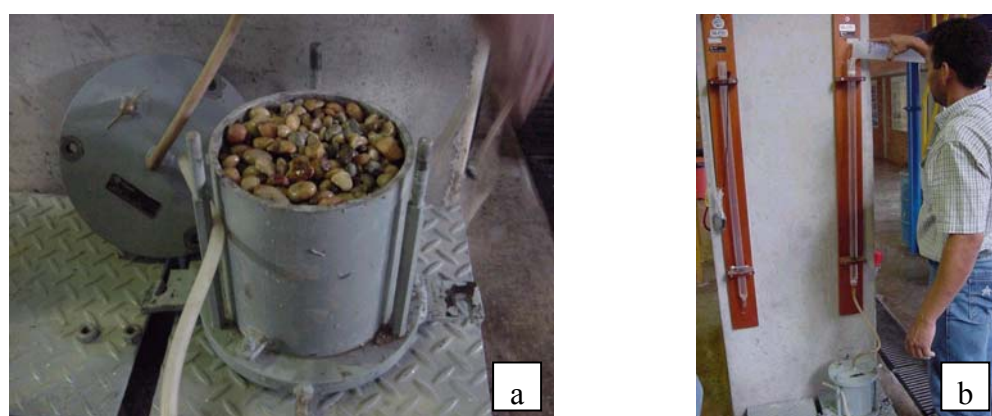
Figura 4.12 : Permeabilidade do concreto fresco. (a) filtro com cascalho; (b) colocação de água na bureta.
