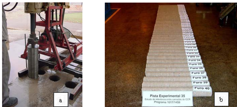
Figura 3.3 : (a)Extração de testemunhos do maciço; (b) aspecto dos testemunhos retirados para ensaios. Estudo de aderência entre camadas de CCR.
