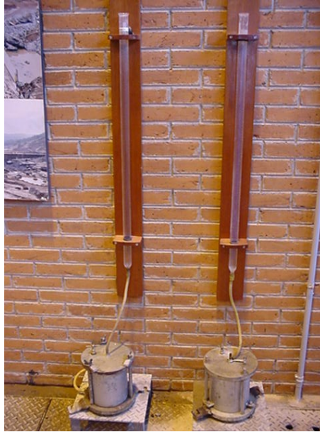
Figura 4.13 : Ensaio de permeabilidade do concreto fresco em andamento.
