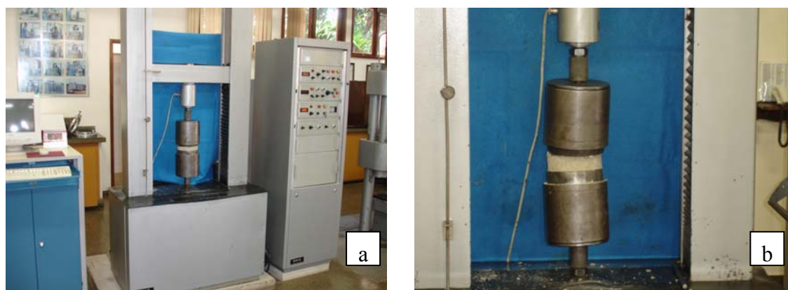
Figura 4.21 : Ensaio de tração direta. (a) equipamento de Ensaio; (b) ruptura do corpo-de-prova.
