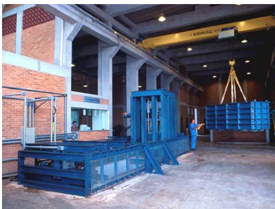
Figura 4.33 : Vista geral do equipamento para compactação de CCR.
