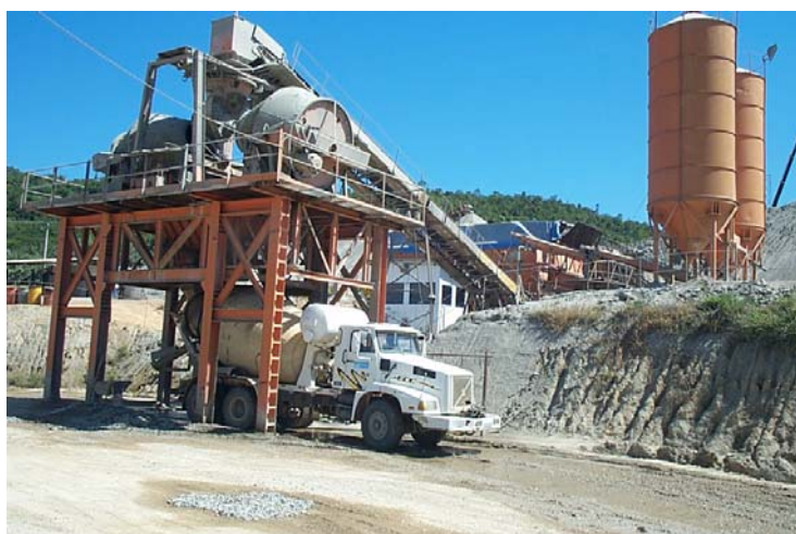
Figura 2.8 : Exemplo de Central convencional utilizada na construção da UHE Mosquitão-GO.
