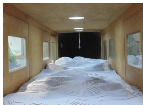
Figura 41 – Vista a barlavento do ângulo de incidência de 288^\circ com mesa auxiliar do modelo reduzido real
