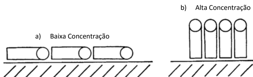
Figura 4.9: Representação esquemática da provável orientação de moléculas de fenol adsorvidas na superfície de grafite em meio aquoso. O círculo representa o anel aromático.
