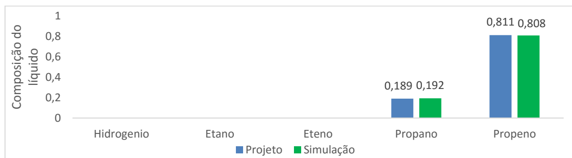
Figura 5.7: Comparação da composição (fração molar) da corrente de fundo da stripper de eteno entre dados de projeto e a simulação
