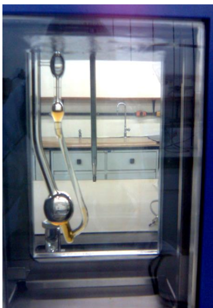
Figura 39. Viscosímetro de Ostwald utilizado para determinação do tempo de escoamento das soluções poliméricas diluídas
