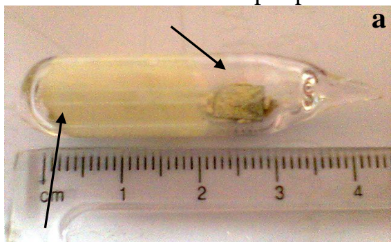
Figura 9 Fotografias de amostras de Ti corroída por pites e o pó de enxofre, a) antes da sulfetação e b) depois da sulfetação.
