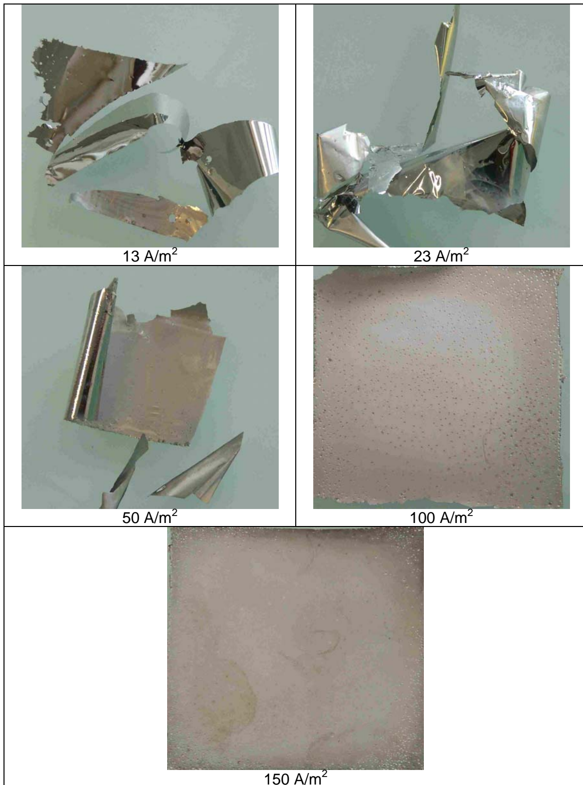
Figura 68 - Morfologia dos depósitos de Ni-Co obtido em densidades de corrente entre 13 e 150 A/m 2 .
