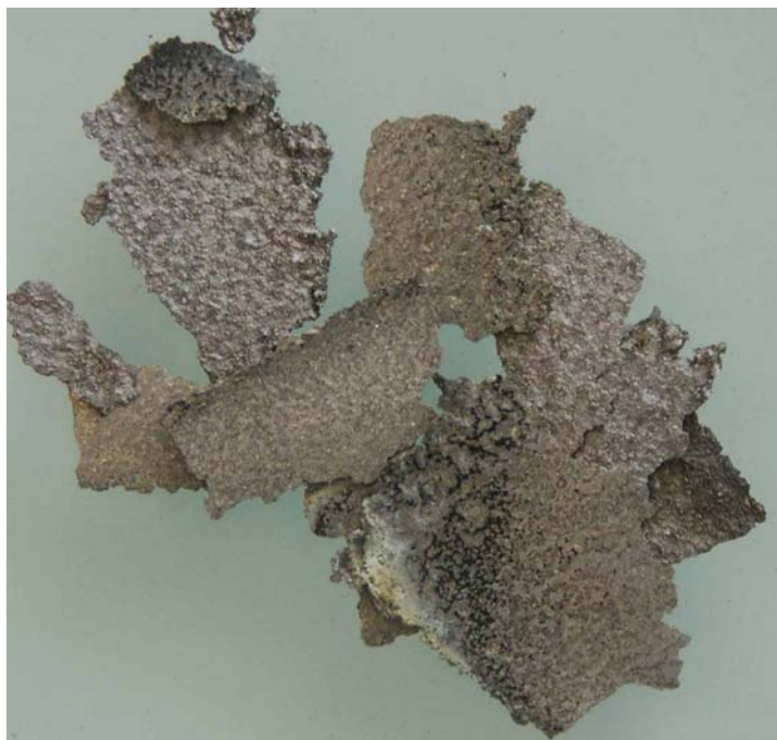
Figura 72 – Morfologia de um depósito obtido a partir de uma solução contendo Ni, Co, Mn e Zn.
