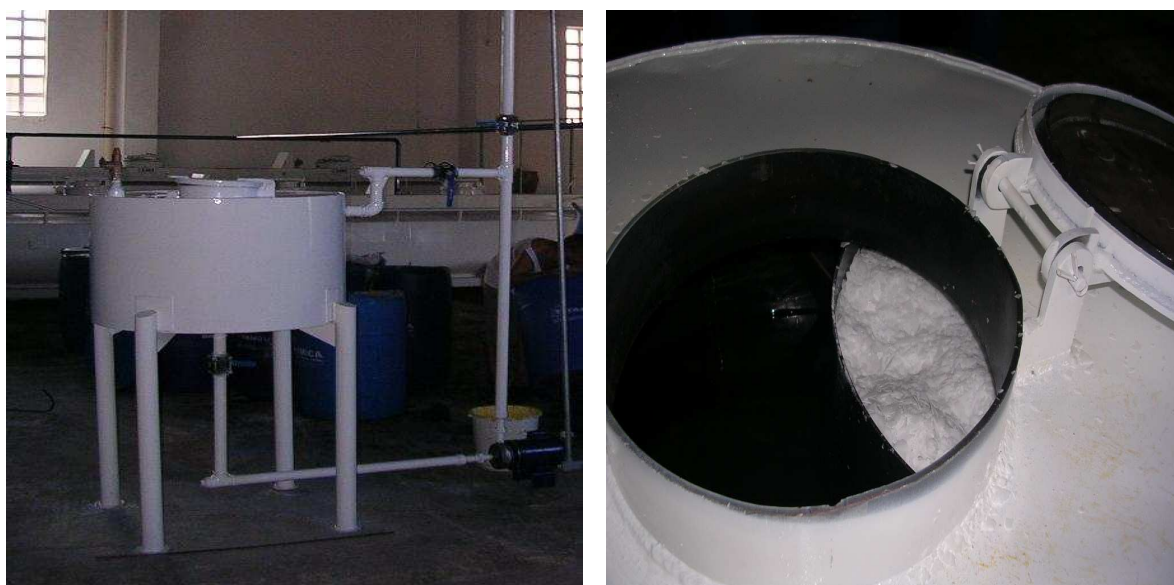
Figura 11: Fotografia do reator de preparação do metóxido: (a) visão geral e (b) detalhe interno, parte da vista superior onde é colocado o KOH
