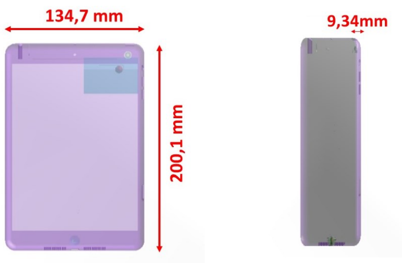
Figura 16 Dimensões do tablet situado na vertical e posicionamento da antena.
