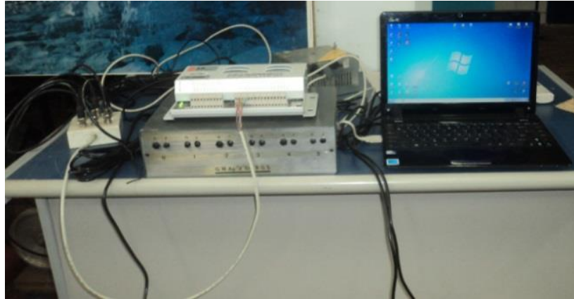
Figura 3.4 – Sistema de aquisição de dados utilizado nas medições experimentais.
