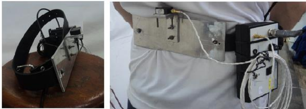
Figura 3.22– Cinto, acelerômetro, condicionador de sinais e sua fixação na cintura da pessoa.
