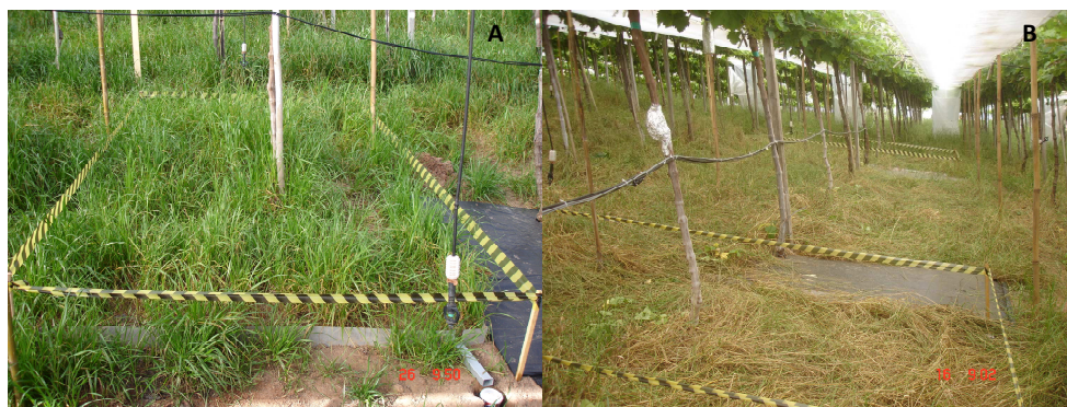
FIGURA 6. Lisímetros instalados na área experimental. Planta “isolada” com chapa galvanizada conformando o lisímetro de compensação (A). Vista do experimento evidenciando dois lisímetros em tratamentos distintos de restrição hídrica (B).
