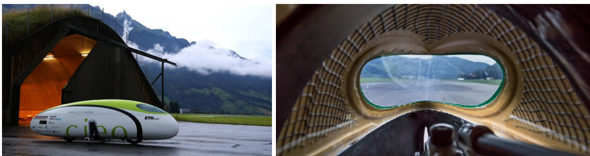
Figura 7: Projeto CIEO, veículo construído à base de fibra de linho e resina ampliTex: a) visão externa e b) visão interna [25]
