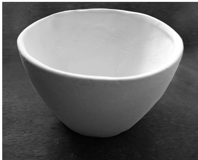
Figura 5: Peça colada da formulação de vidro (V). [Figure 5: Casted part of glass composition (V).]
