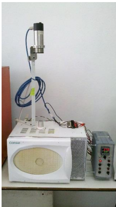
Figura 58: Forno de microondas adaptado para sinterização de amostras cerâmicas.
