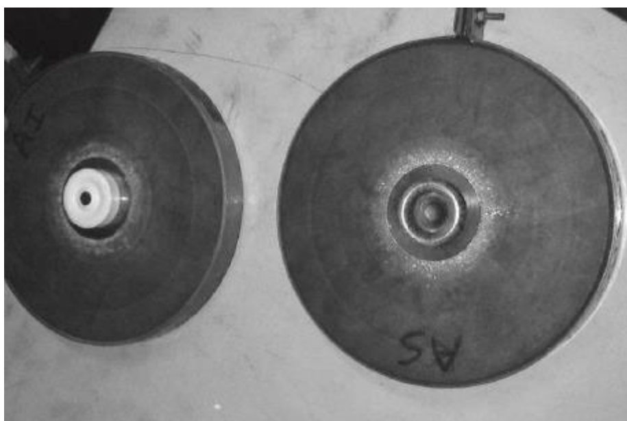
Figura 17: Posicionamento da gaxeta na câmara, antes do processo de sinterização em alta pressão.
