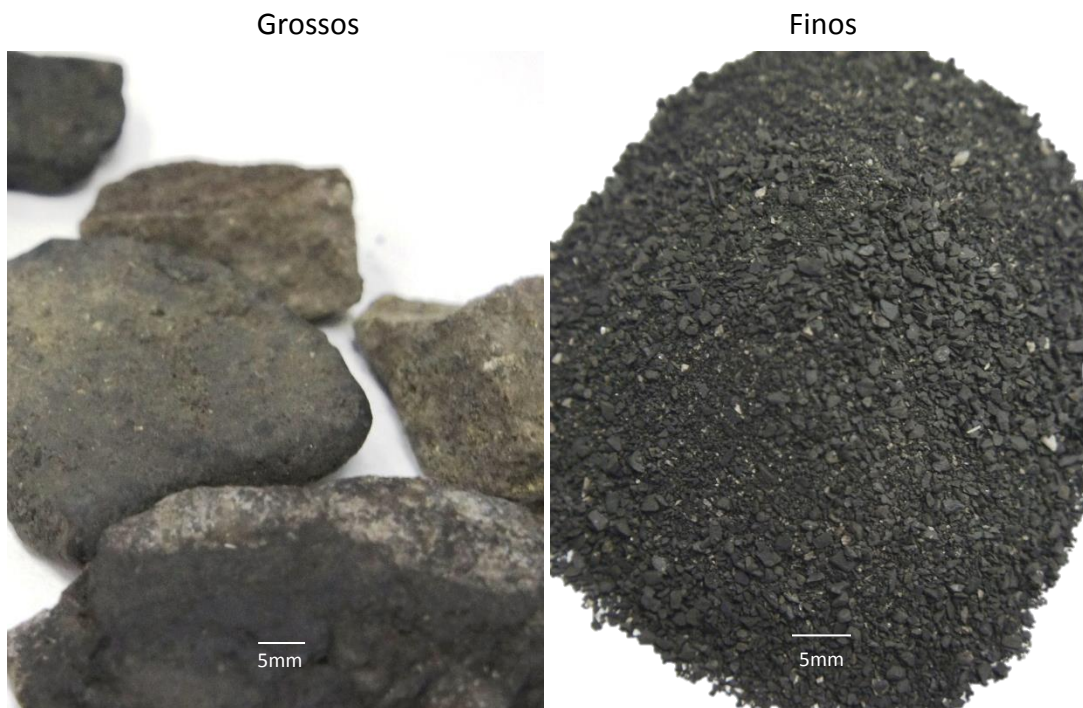
Figura 25: Imagens da fração intermediária ( 2,2 < d < 2,7 ) obtida nos ensaios densimétricos.
