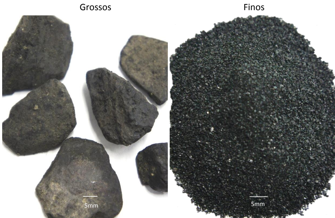
Figura 24: Imagens da fração energética (d<2,2) obtida nos ensaios densimétricos.
