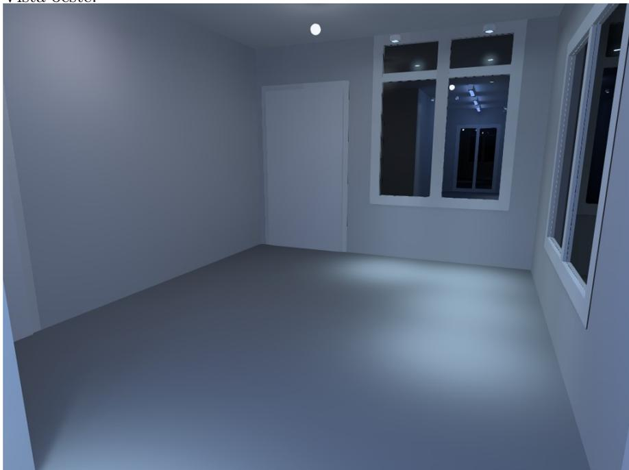
Figure 12: Simulação de iluminação da sala e cozinha com lampadas fluorescentes compactas, tubulares e halógenas. Vista oeste.
