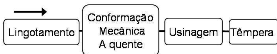
Figura 2.22: Representação geral do processo de manufatura de anéis para rolamentos 69 .
