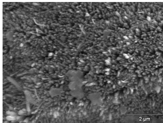
Figura 3.7 – Ampliação da formação de filme de ZnO em três horas de síntese (ampliação de 15000 vezes).
