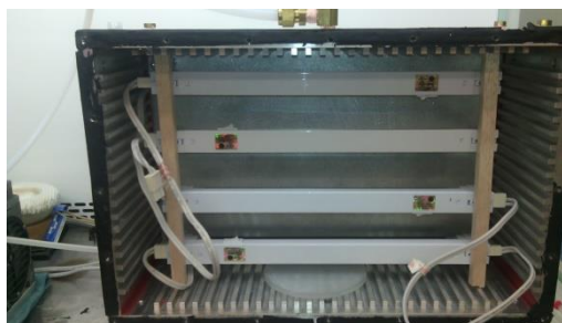
Figura 3.21 – Melhoria implementada no reator de aço inoxidável: lã de vidro impregnada com fotocatalisador colocada na parede do reator e quatro lâmpadas voltadas para o catalisador.
