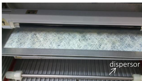
Figura 3.20 – Melhoria implementada no reator de aço inoxidável: instalação de um dispersor de fluxo.
