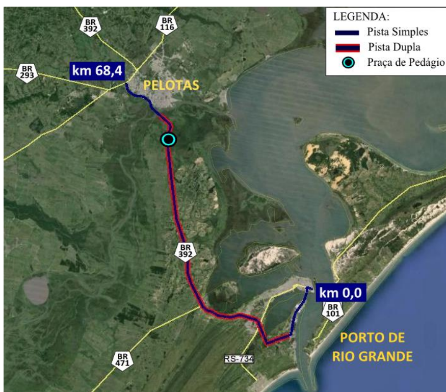
Figura 5 – trecho da BR-392 entre o Porto de Rio Grande e o município de Pelotas
