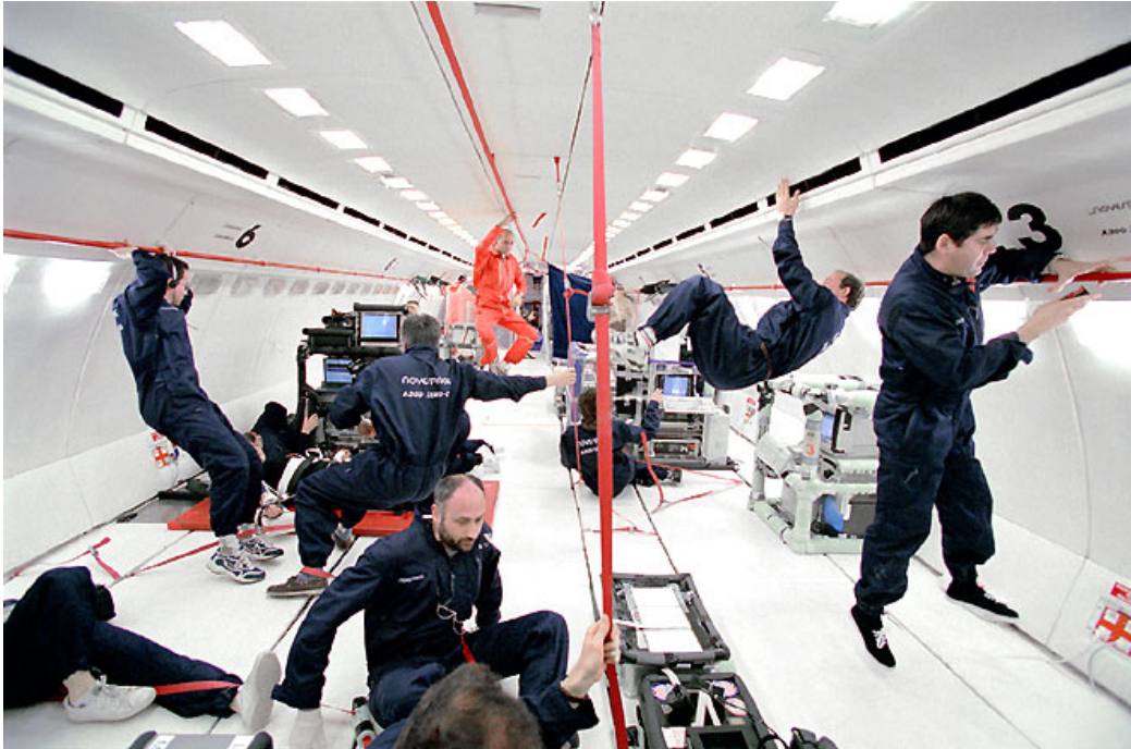
Figura 13 – Área de testes durante a microgravidade. A iluminação da cabine se mantém uniforme durante o voo. Paredes laterais, superior e inferior acolchoadas.
