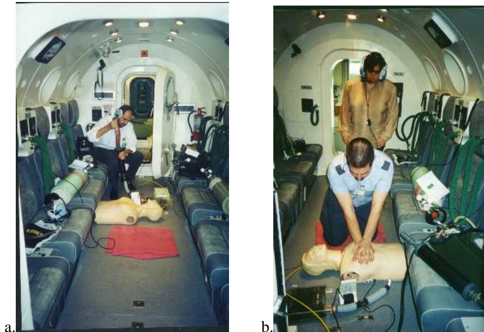
Figura 19 – Interior da câmara hipobárica, compartimento maior. Disposição do manequim no solo da câmara; a. calibração de gases e volumes, b. RCP ao nível do mar (porta da câmara aberta).
