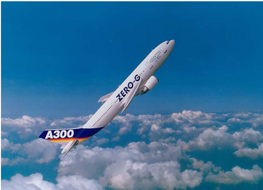
Figura 11 – Atitude de vôo no início da parábola, em ângulo de 47 graus em relação ao plano horizontal.
