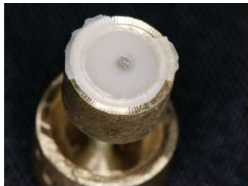
Figura 4. Corpo de prova, após polimerização e remoção da matriz, ainda com excessos.
