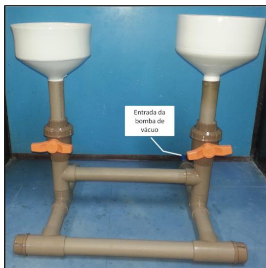
Figura 16: Filtro de Buchner em estrutura de tubos de PVC usados para confecção de membrana de celulose.
