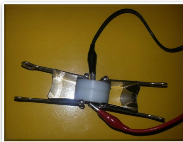
Figura 18: Célula montada utilizada no ensaio de EIS.
