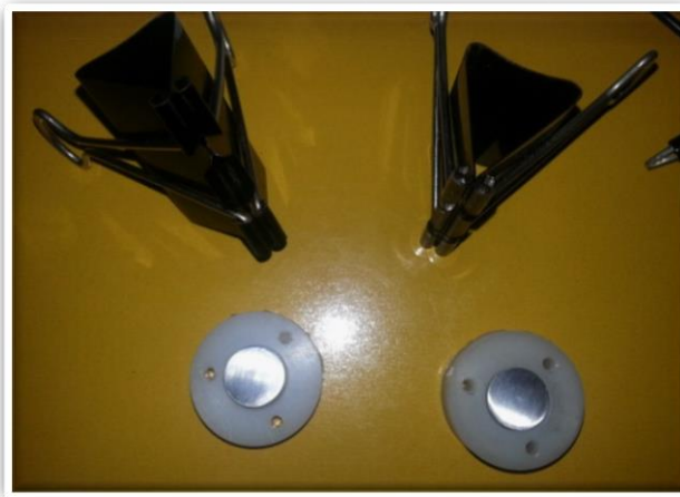
Figura 17: Componentes da célula utilizada no EIS.
