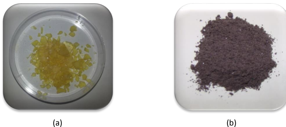
Figura 25: Fotografia da resina de copolímero de indeno-estireno antes (a) e após (b) sulfonação.
