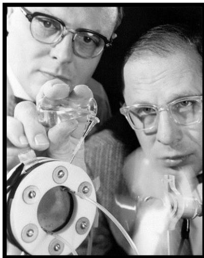
Figura 3: PEMFC de Grubb e Niedrach em 1960 [8].
