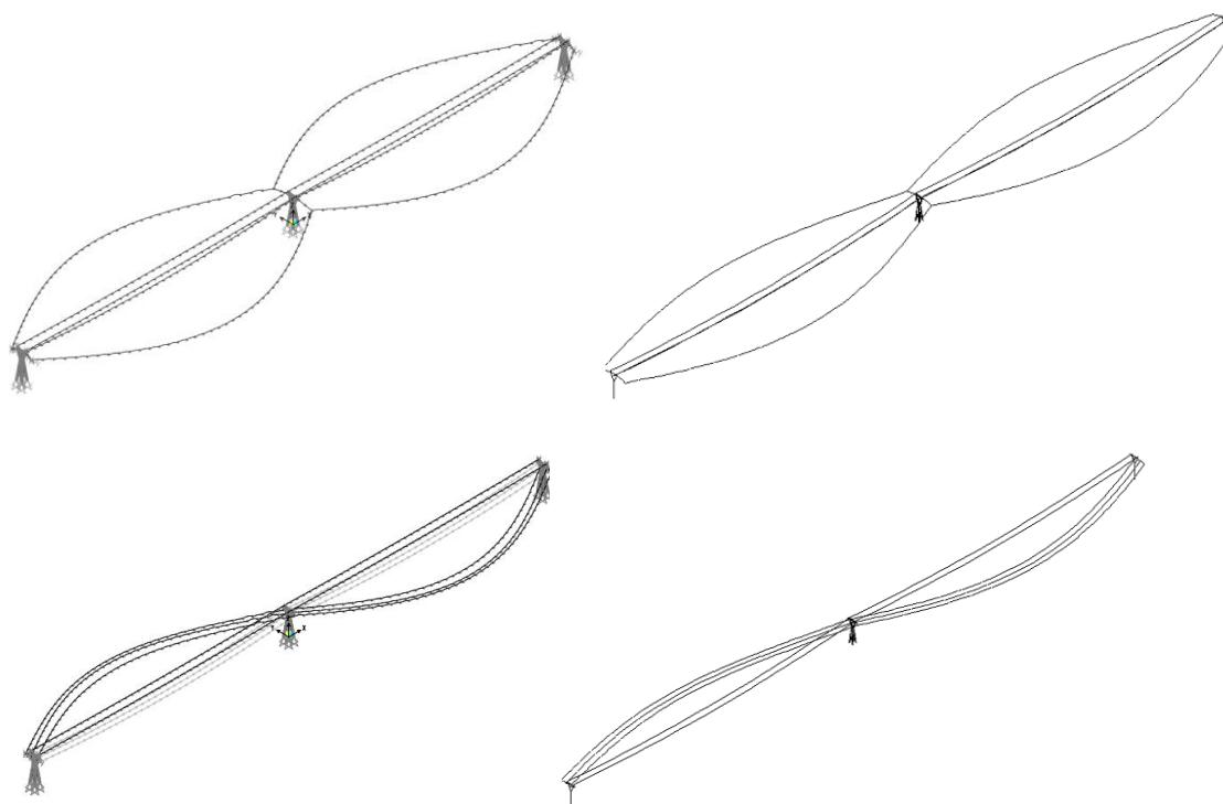
Figura 3. 13 – Representação das formas modais 1, 3 e 4 respectivamente do sistema composto por cabos e torres [esquerda presente investigação e direita estudo de (OLIVEIRA, 2006).
