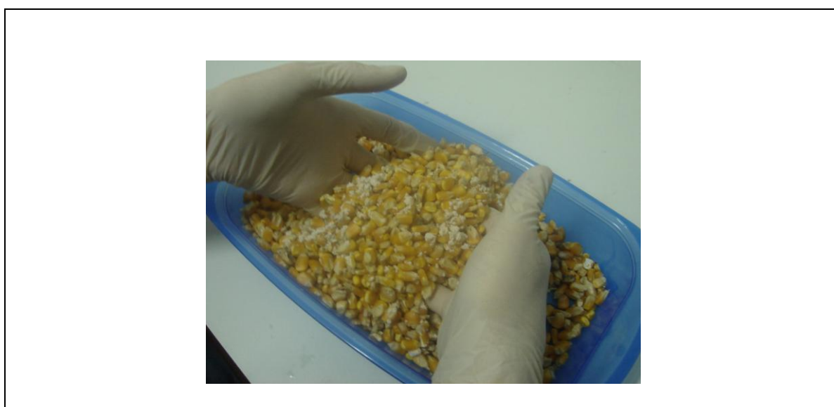
FIGURA 9. Homogeneização manual de grãos de milho com terra de diatomácea.
