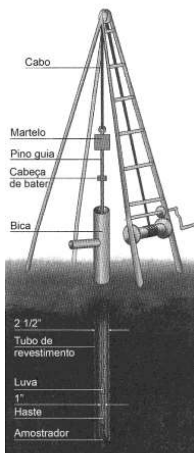
Figura 2 – Partes do equipamento de sondagem SPT
