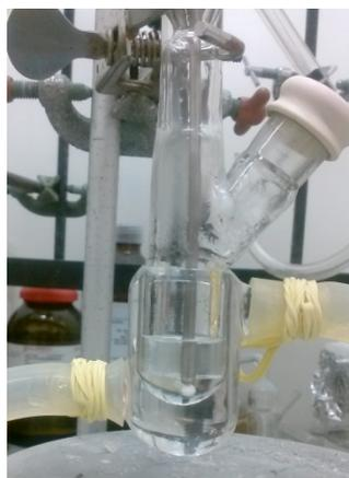
**Figura 58.** Reator de vidro provido de camisa externa de aquecimento utilizado para os testes de solubilidade.
