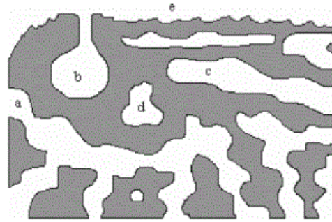
Figura 1 - Sólido poroso e seus diferentes tipos de poros: (a), (b), (c) abertos, sendo (b) gargalo de garrafa, (c) cilíndrico; (d) fechado; (e) rugosidade da superfície [13] .
