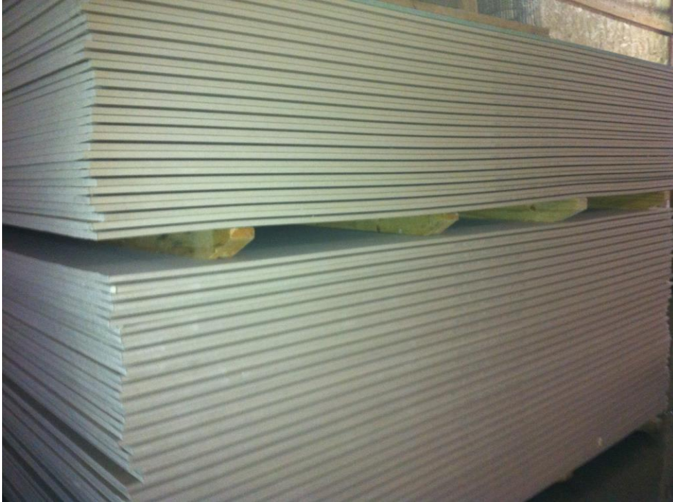
Figura 22 – Estocagem das placas de gesso
