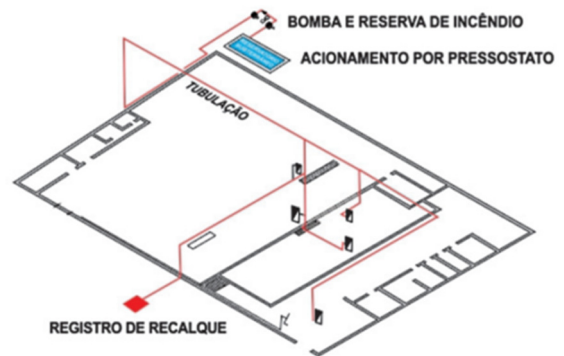
Figura 22 – Perspectiva do sistema de hidrantes
