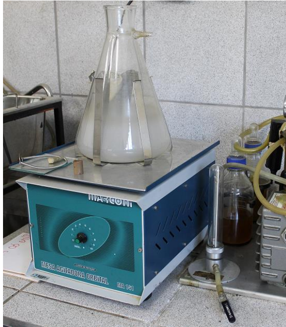
Figura 16 – Determinação da densidade máxima medida através do método Rice
