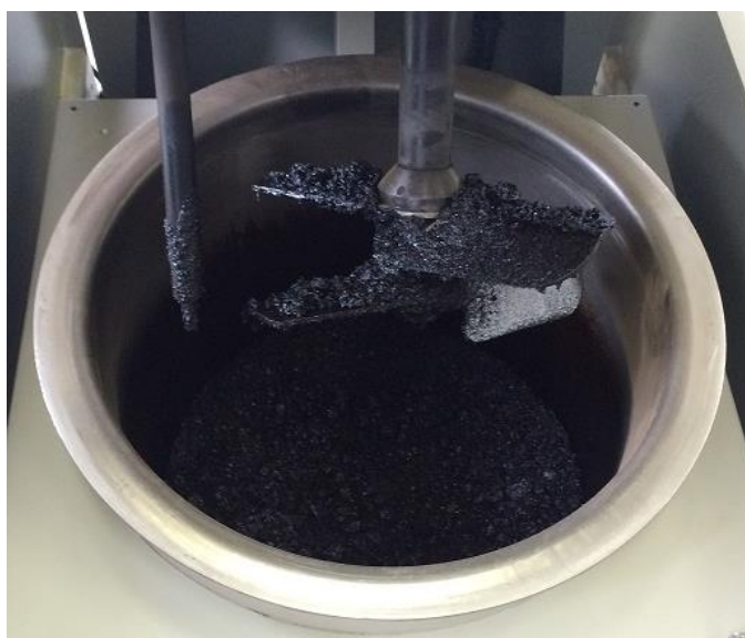
Figura 11 – Processo de mistura no laboratório
