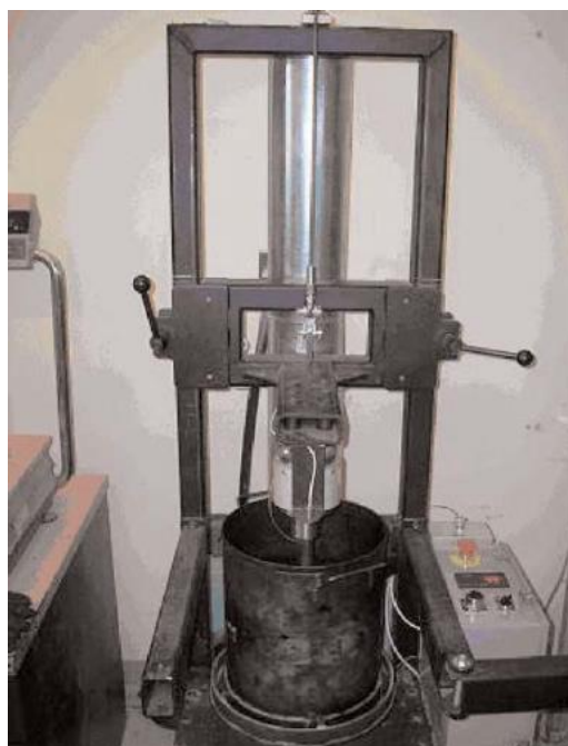
Figura 4 – Dispositivo para medição de trabalhabilidade da Universidade de Massachussets
