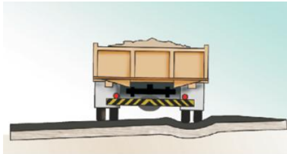
Figura 12 b – Deformação permanente no sistema
