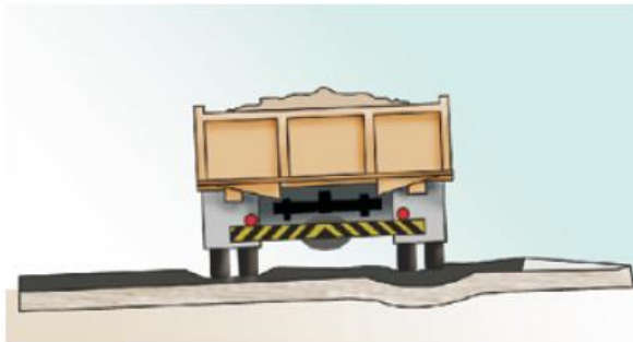
Figura 12 a – Deformação permanente no revestimento
