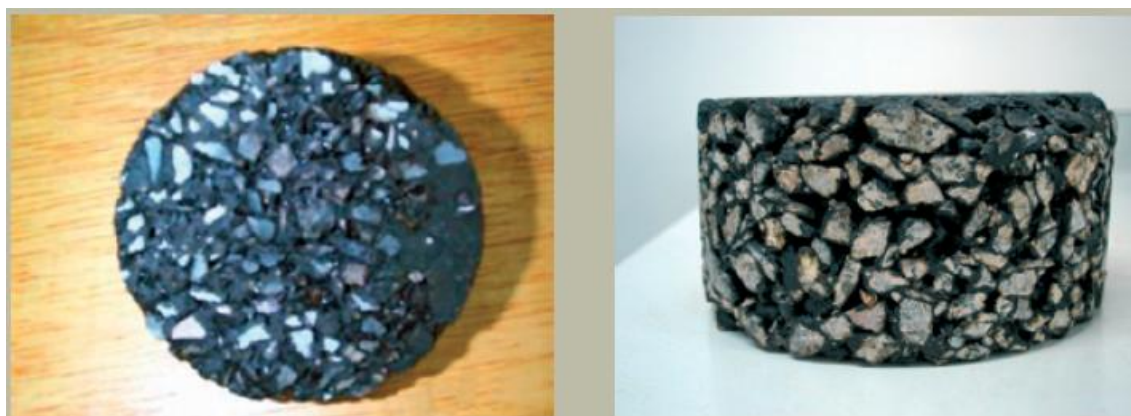
Figura 6 – Corpos de prova de mistura asfáltica a quente
