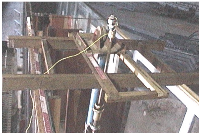
Figura 3.4 – Ponta linimétrica fixada ao carrinho móvel sobre o canal.
