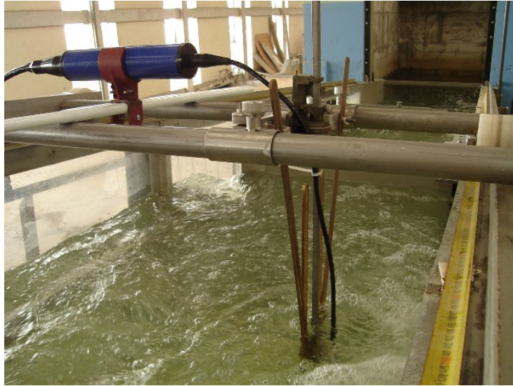
Figura 3.18 – Carrinho móvel sobre o canal onde é preso o ADV.
