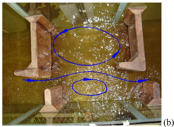
Figura 3.2 – (a) esquema em planta de um tanque do modelo com as principais dimensões; (b) vista do mesmo no modelo (as setas indicam o sentido do escoamento médio).
