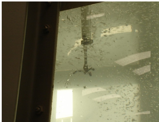
Figura A2.4 – Posição de medição selecionada para a avaliação dos filtros com presença de bolhas de ar.
