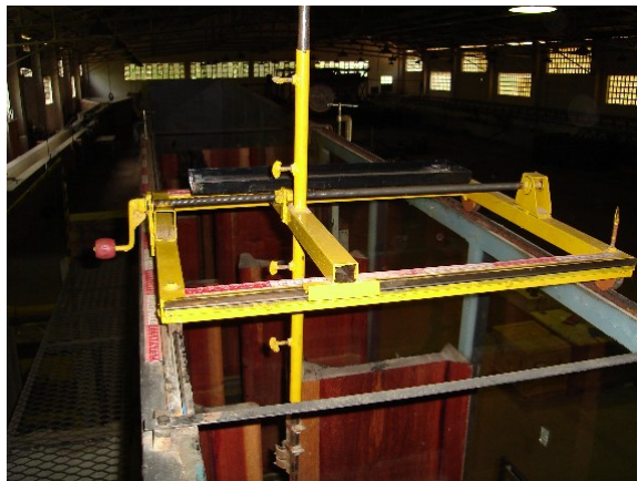
Figura 3.11 – Carrinho móvel sobre o canal para fixação do ADV nos pontos de medição.
