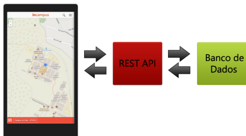
Figura 4.2 - Arquitetura geral da aplicação Aplicação móvel híbrida
