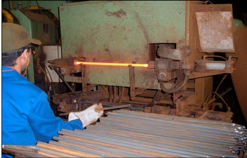
Figura 12 - Aquecimento por processo elétrico-resistivo para facilitar o dobramento, as barras são aquecidas para a temperatura de 950°C. Foto cedida pela IAT Ltda.
