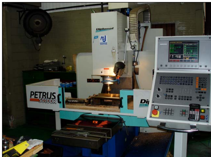
Figura 35 - Fresadora CNC Petrus 50100R, onde foram usinadas as Navalhas de Corte. Foto cedida pela Metalúrgica Joper Ltda.
