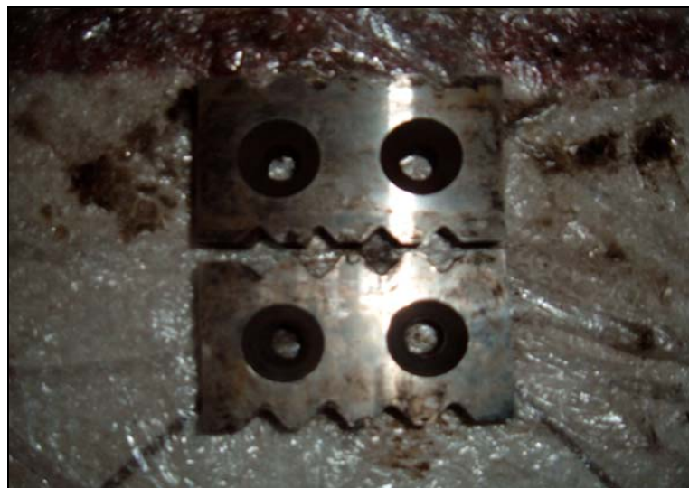
Figura 54 - Navalhas de Corte em aço AISI D2 com dureza de 59 HRC após o uso. Foto cedida pela IAT Ltda.
