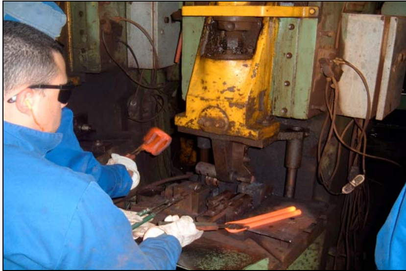
Figura 14 – A segunda e terceira dobras de conformação dos grampos são realizadas pela mesma prensa. Existem duas matrizes para as dobras. Foto cedida pela IAT Ltda.
