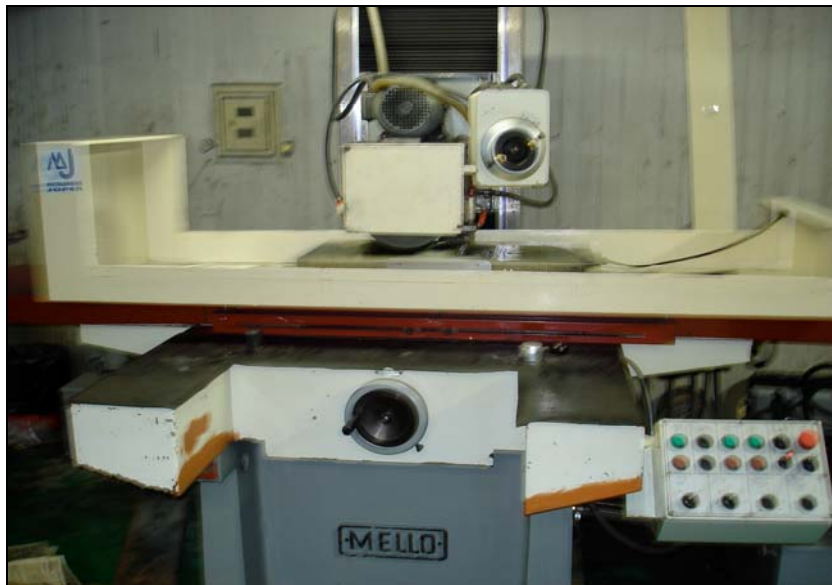
Figura 38 - Retificadora Plana, as peças foram acabadas após o tratamento térmico. Foto cedida pela Metalúrgica Joper Ltda.
