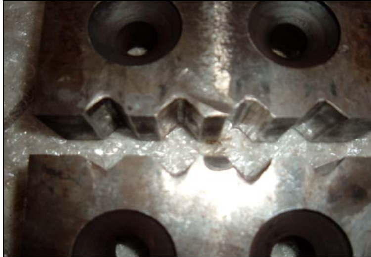
Figura 65 - Detalhe dos rasgos com desgaste e inclusive com algumas fissuras. Foto cedida pela IAT Ltda.
