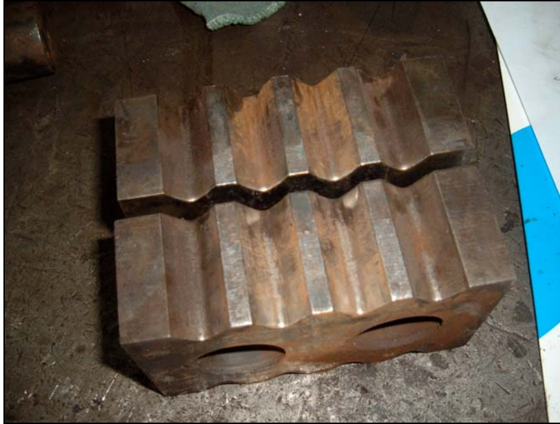
Figura 61 - Vista superior das Navalhas de Corte em aço AISI S1 com dureza 56 HRC após o uso. Foto cedida pela IAT Ltda.
