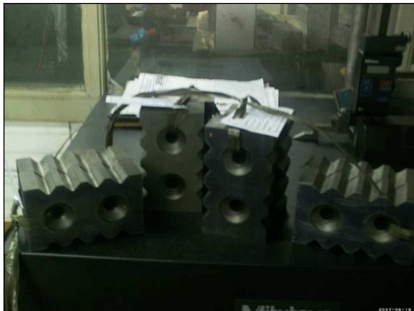
Figura 37 - Peças já usinadas e sendo devidamente marcadas para o tratamento térmico. Foto cedida pela Metalúrgica Joper Ltda.
