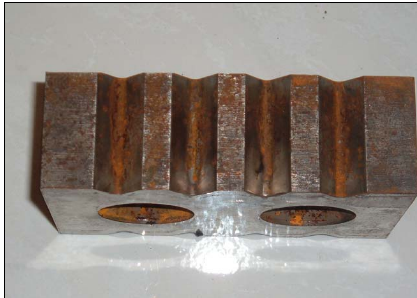
Figura 44 - Navalha de Corte em aço AISI D6 com 60 HRC após cerca de 100 mil peças cortadas, visualização do desgaste nas extremidades dos canais. Foto cedida pela IAT Ltda.
