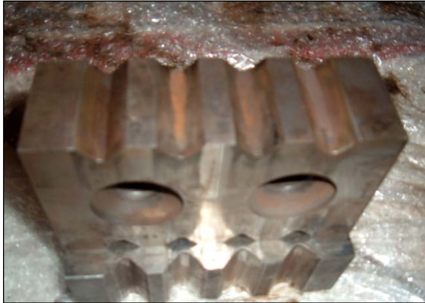
Figura 55 - Mostra um maior desgaste nos rasgos superiores.
