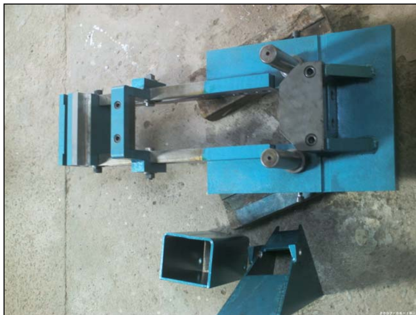
Figura 42 - Matriz de Corte desmontada, para visualização das partes.
