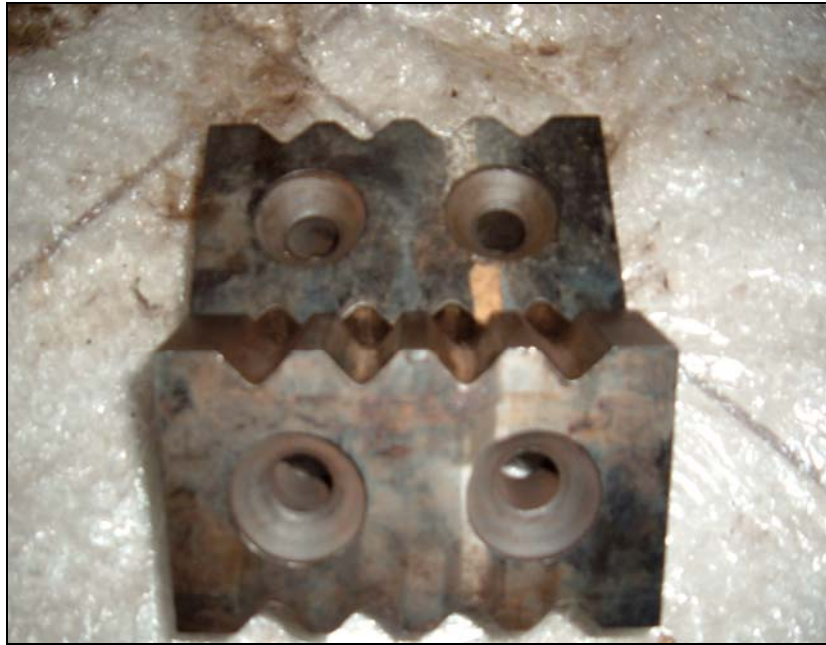
Figura 68 - Detalhe dos rasgos da Navalha de Corte, na qual é possível visualizar desgaste. Foto cedida pela IAT Ltda.
