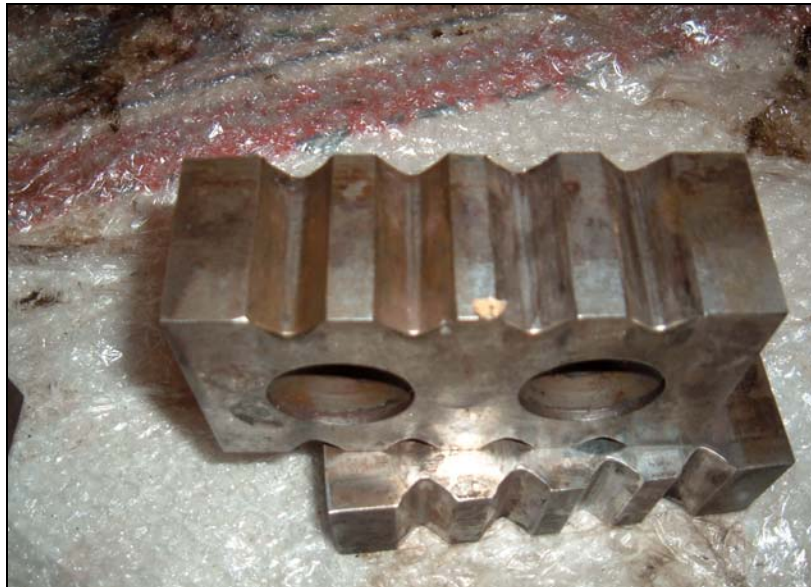
Figura 51 - Vista superior da Navalha de Corte que mostra o excessivo desgaste nos rasgos. Foto cedida pela IAT Ltda.
