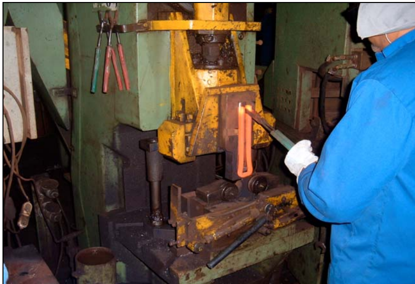
Figura 13 - Primeira dobra de conformação dos Grampos Elásticos. Foto cedida pela IAT Ltda.
