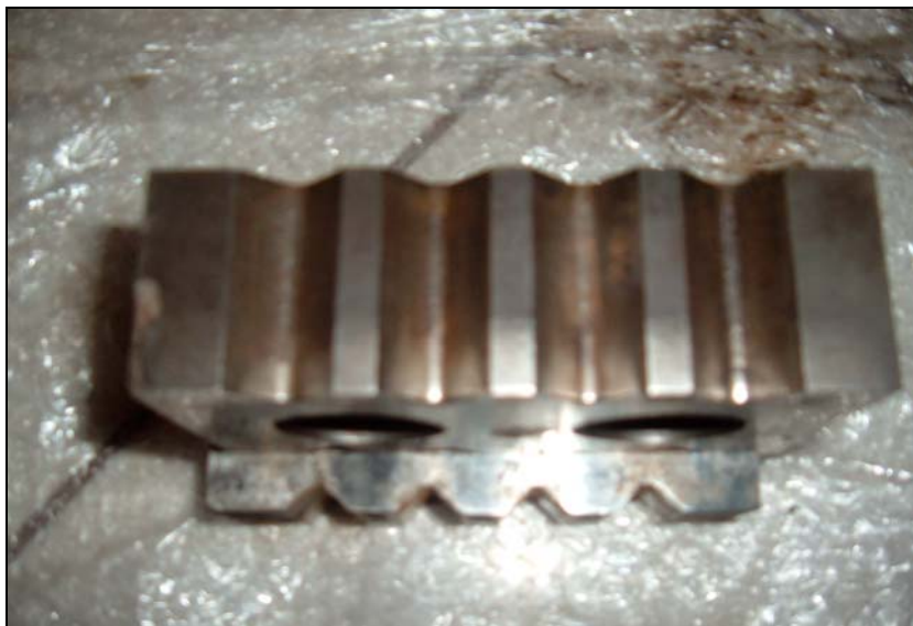
Figura 53 - Detalhe que mostra os rasgos sem muito amassamento e desgaste. Foto cedida pela IAT Ltda.
