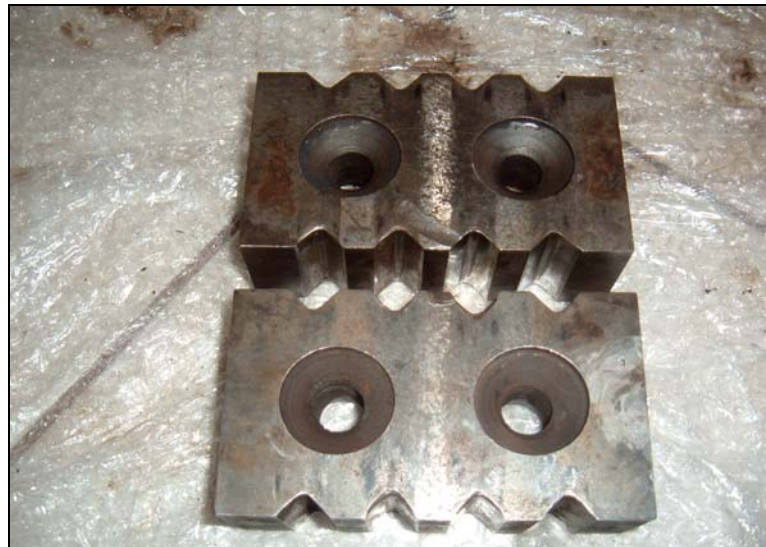
Figura 64 - Navalhas de Corte em aço AISI H13 com dureza de 56 HRC. Foto cedida pela IAT Ltda.
