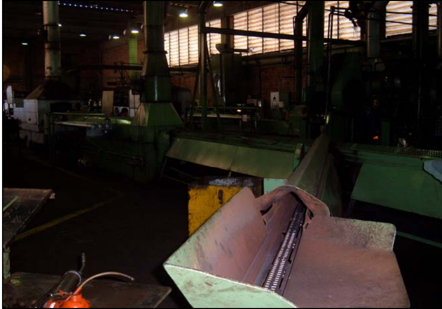
Figura 16 - Esteira onde as peças são encaminhadas para o tratamento térmico. Foto cedida pela IAT Ltda.
