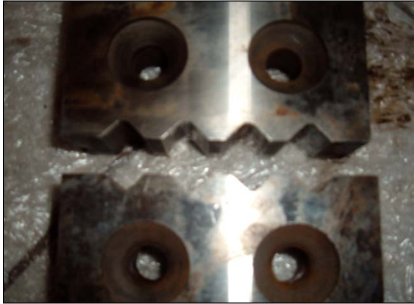
Figura 59 - Navalhas de Corte em aço AISI S1 com 59 HRC após o uso, para visualização do desgaste nos rasgos. Foto cedida pela IAT Ltda.
