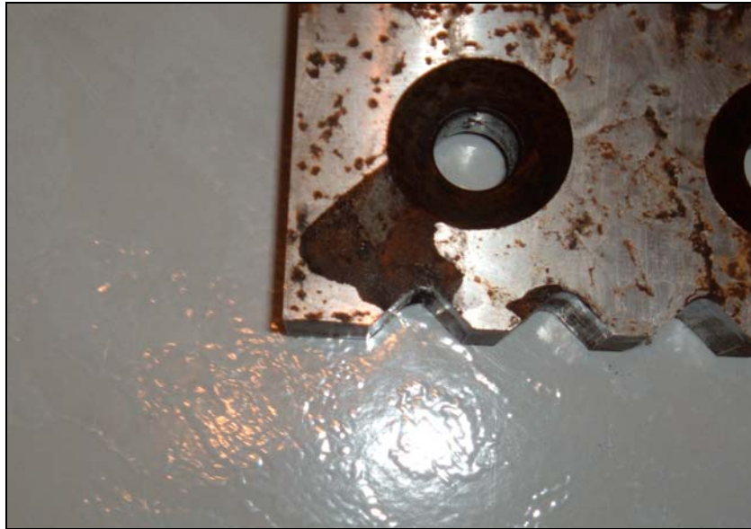
Figura 47 - Fissuramento em um rasgo de corte na navalha superior. Foto cedida pela IAT Ltda.
