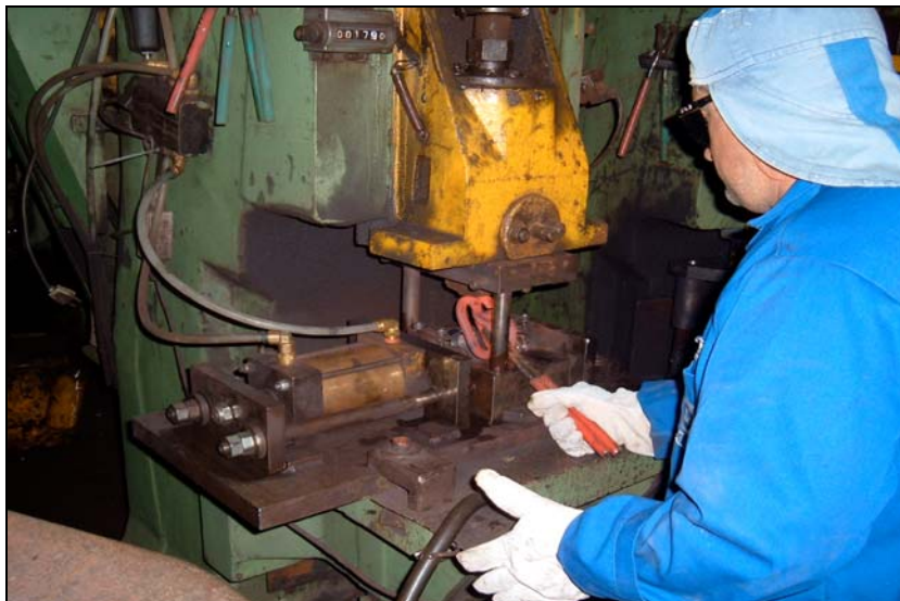
Figura 15 - Quarta dobra de conformação dos Grampos Elásticos. Foto cedida pela IAT Ltda.
