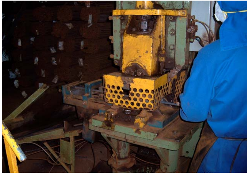
Figura 11 - Primeira etapa da fabricação: prensa realizando os cortes das barras. Ao fundo, as barras estocadas. Foto cedida pela IAT Ltda.
