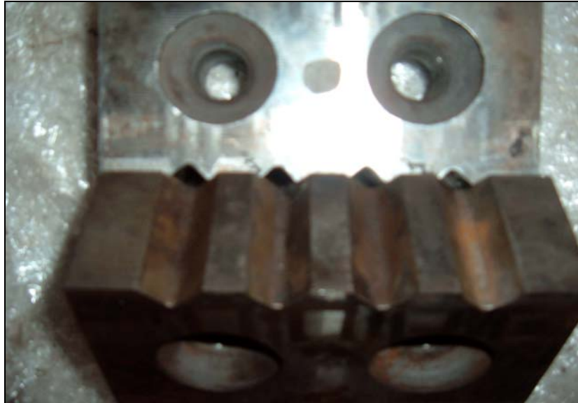
Figura 63 - Mostra o detalhe do desgaste nos rasgos.
