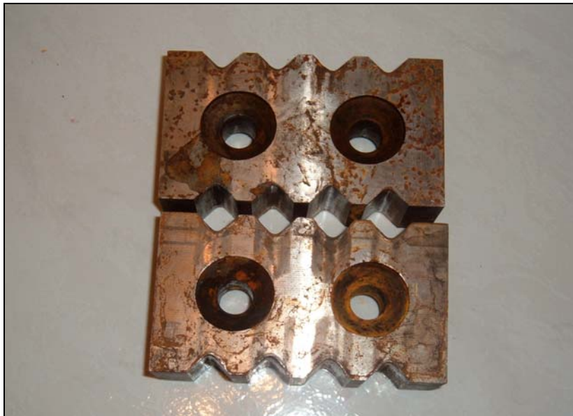
Figura 46 - Navalhas de Corte em aço AISI D6 com 60 HRC após o uso. Foto cedida pela IAT Ltda.
