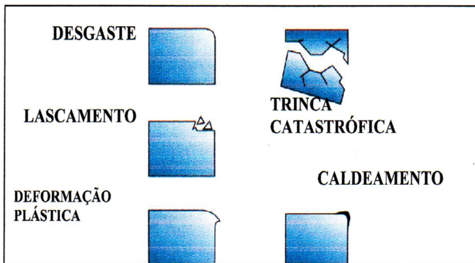
Figura 2 - Ilustração esquemática dos mecanismos de falha em ferramentas.
