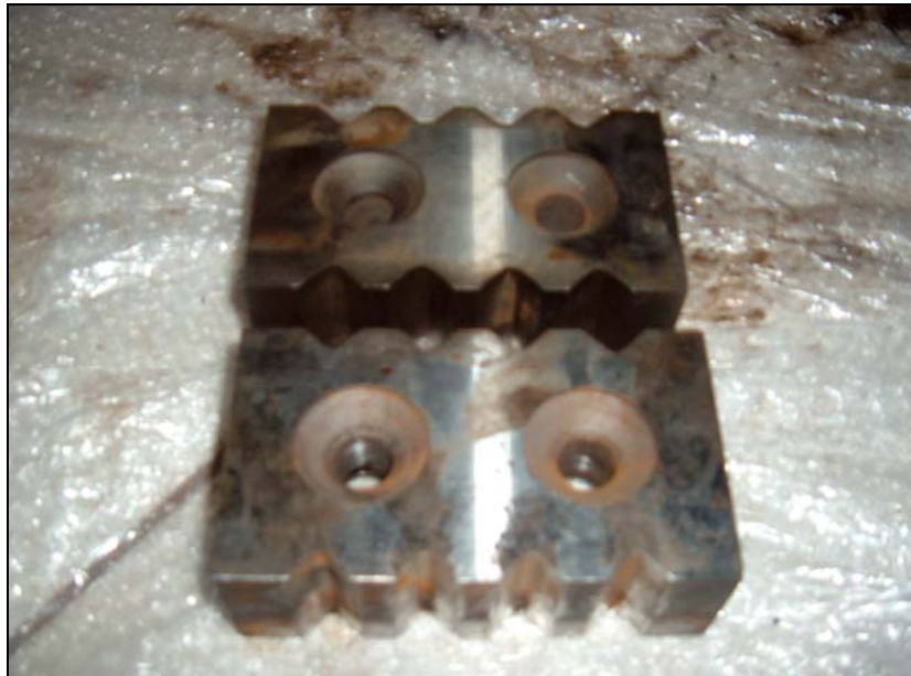
Figura 58 - Navalhas de Corte em aço AISI S1 com 59 HRC após o uso. Foto cedida pela IAT Ltda.
