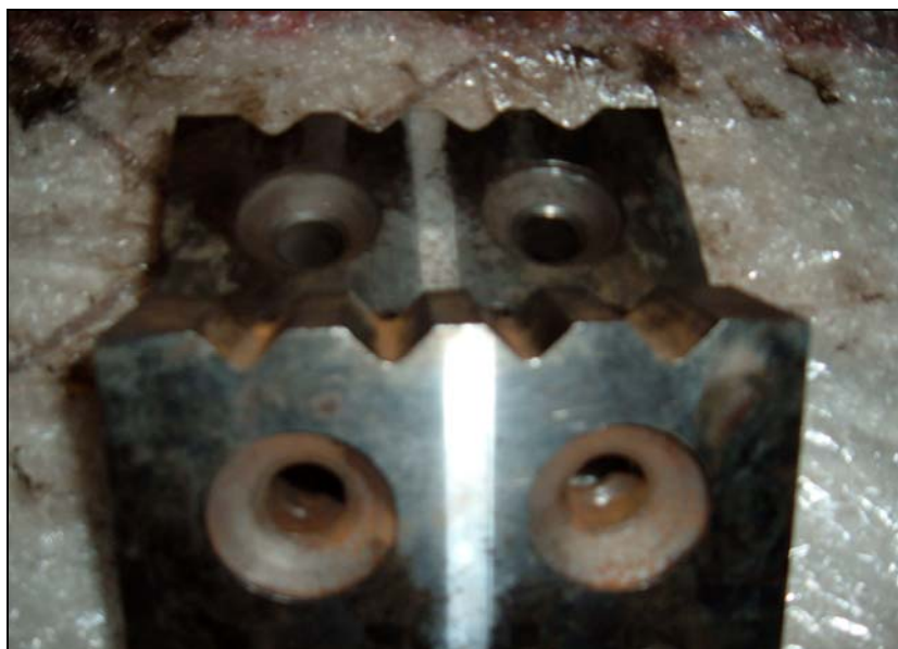
Figura 57 - Vista superior das Navalhas, destacando o desgaste nos rasgos. Foto cedida pela IAT Ltda.
