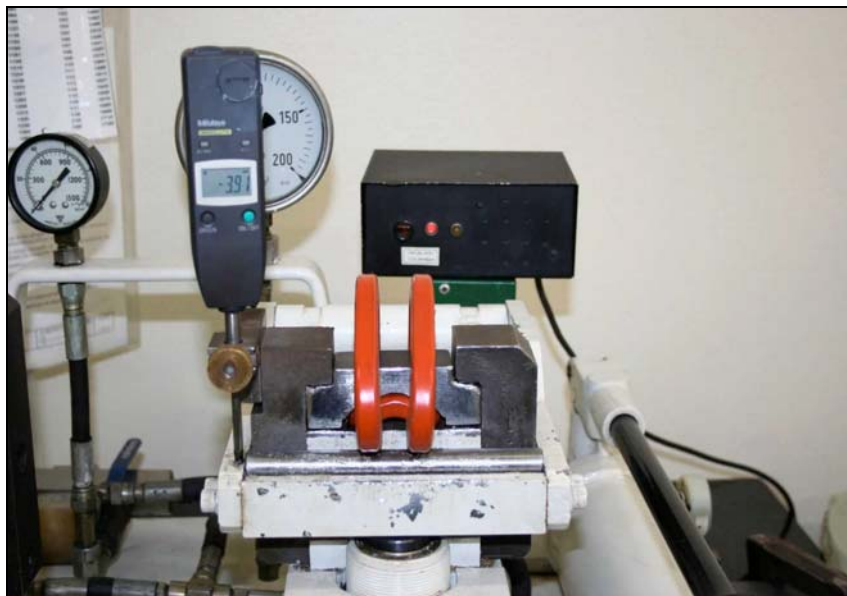
Figura 19 – Equipamento utilizado para realização do ensaio estático. Foto cedida pela IAT Ltda.
