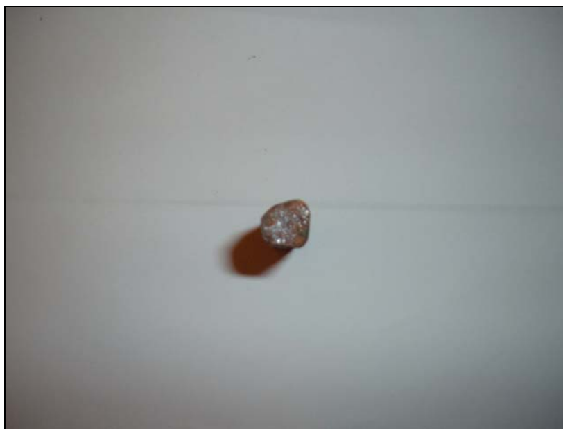
Figura 45 - Secção da barra cortada com deformação.
