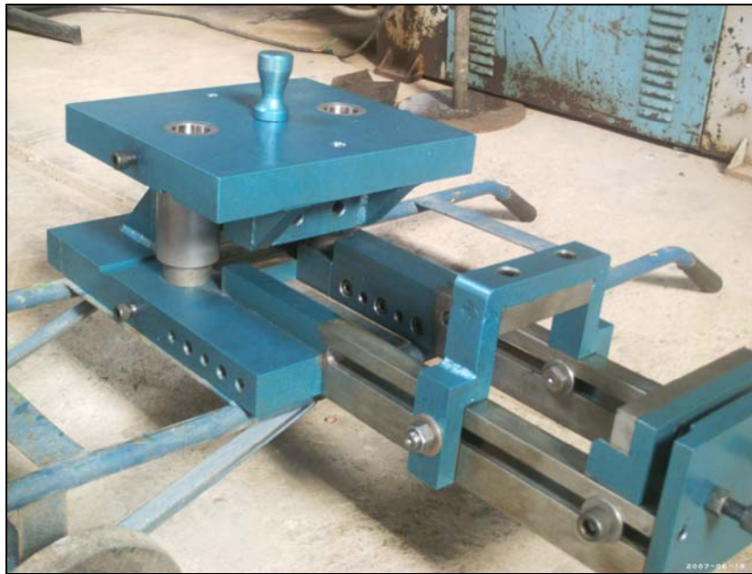
Figura 41 - Matriz de Corte concluída, pronta para testes.
