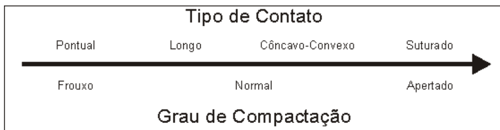
Figura 4.2: Grau de compactação em função do tipo de contato.
