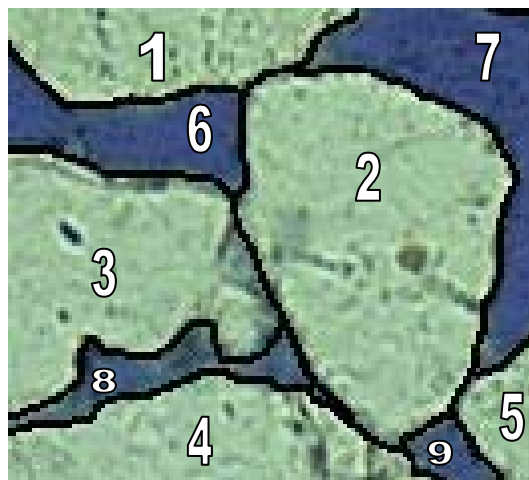
Figura 5.9: Presença de Grãos e poros em uma lâmina de rocha.
